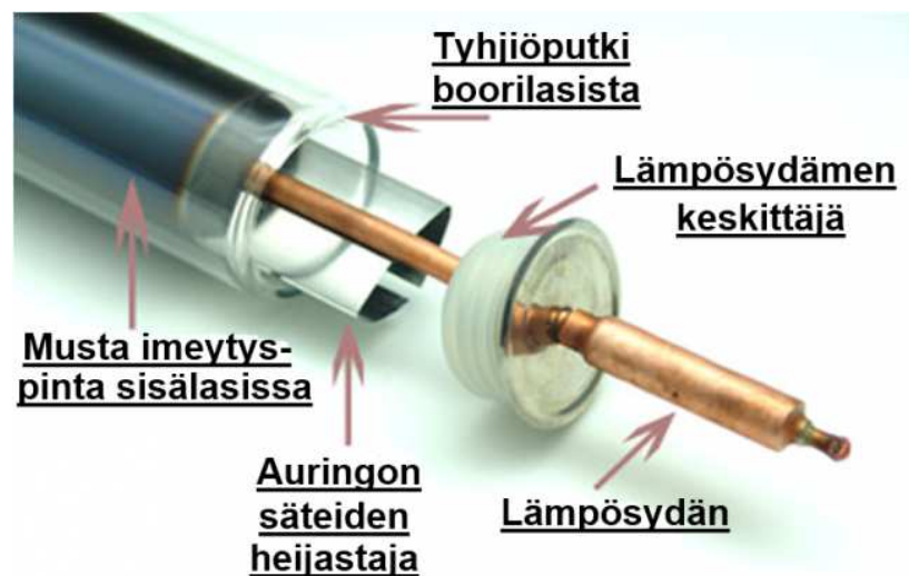
Kuva 10. Tyhjiöputken rakenne [19]
