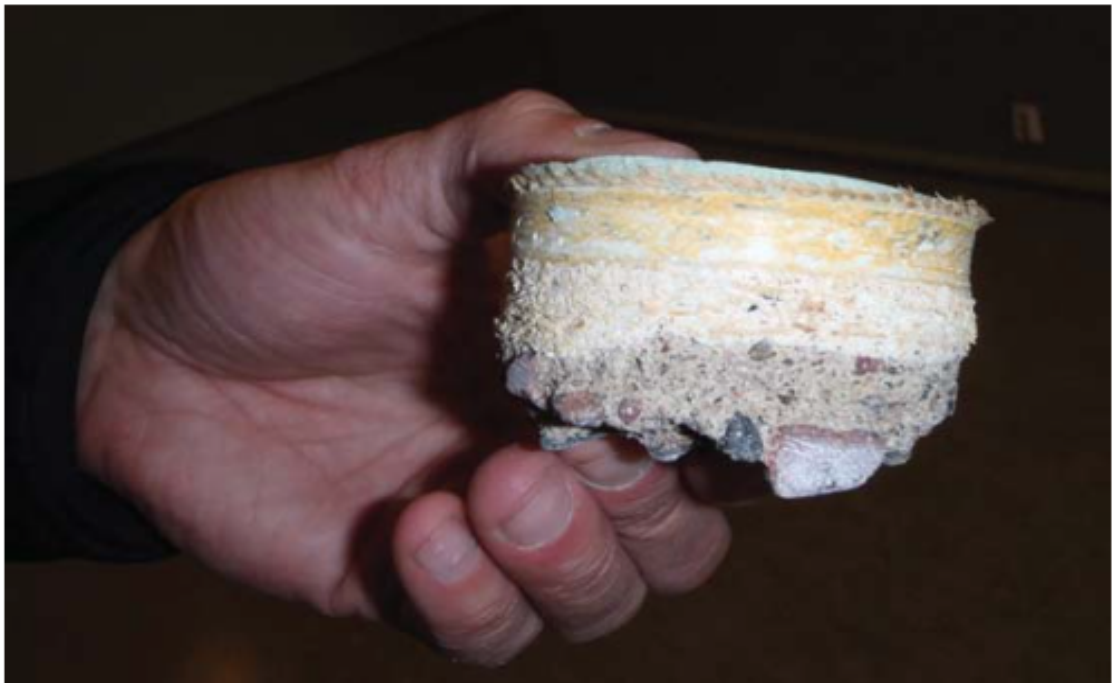
Kuva 28. Kerrokselliset rakenteet voivat sisältää myös aineksia useista remonteista jopa eri vuosikymmeniltä. Näytteessä on pintakerroksena PVC-muovimatto, jonka alla on 1970-luvun magnesiamaassakerros, ja toinen vastaava kerros 1950-luvulta [23].
