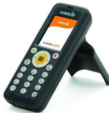
Kuvio 8. Harjoituksessa käytetty Nordic ID:n Morphic RFID- käsilukija (Nordic ID, Morphic 2015)
