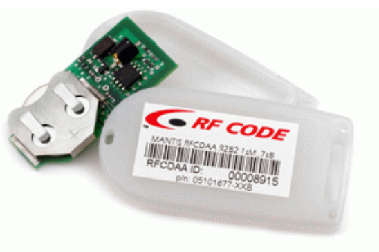
Kuvio 4. Virtalähteellä varustettu aktiivinen RFID- tunnistee (Real Time ID 2015)
