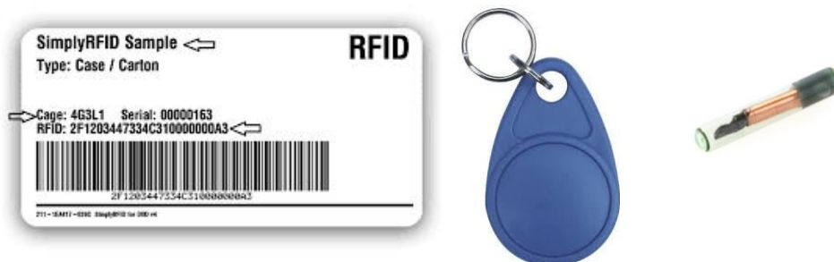
Kuvio 3. Esimerkkejä RFID- tunnisteista. Tarratunniste, kulunvalvontaan tarkoitettu muovinen tunniste ja lasinen kapselitunniste. (Simply RFID 2015, Probyte 2015 & Sparkfun 2015.)
