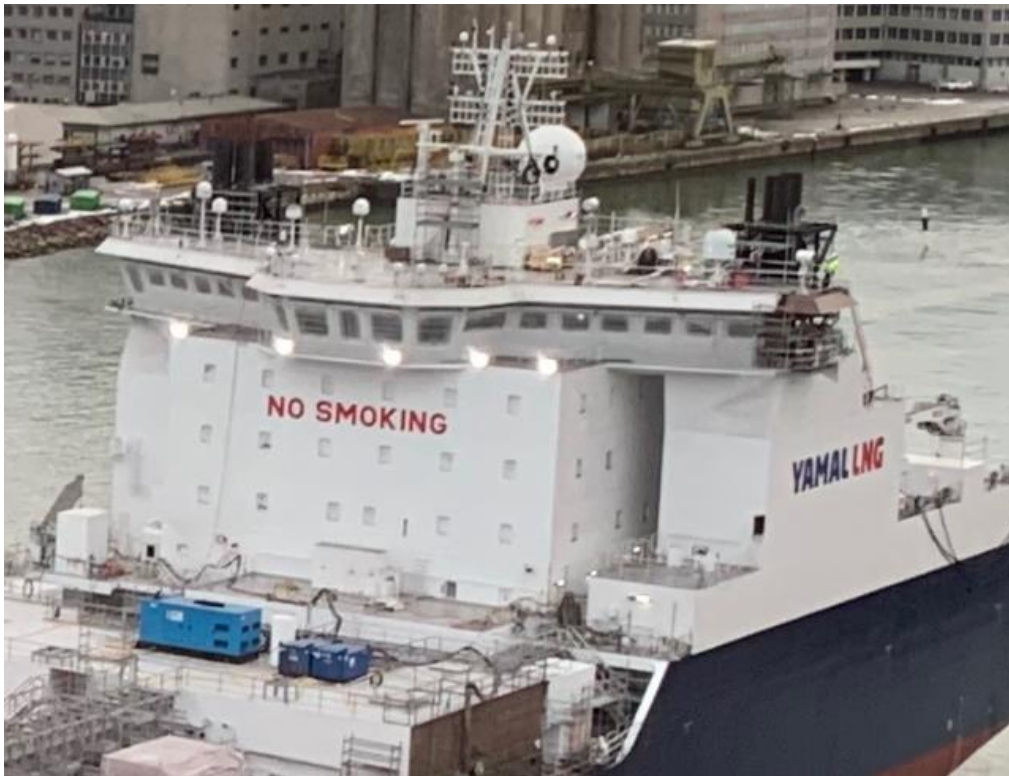
Kuva 2. Tankkerin kansimökki. Sisältää laivan henkilökunnan asuintilat sekä ohjaushytin [10].
