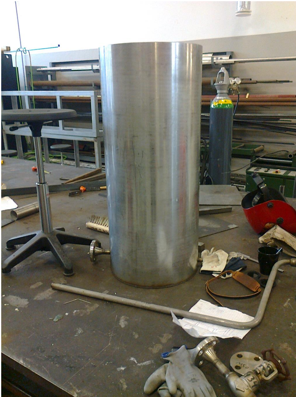
Kuvio 4. Säiliöstä on testattu hitsaus saumat valmistuksen ja se on valmiina lopulliseen tarkastukseen
