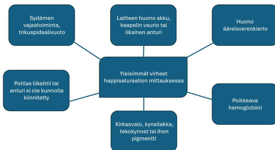
KUVA 1. Happisaturaation mittaamisen mahdollisia virhelähteitä.
