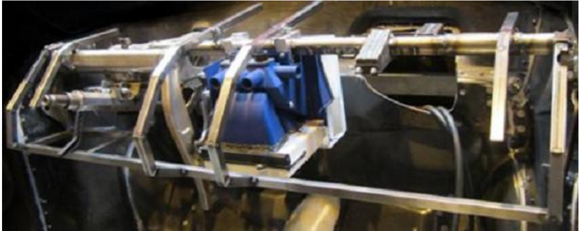
Kuva 24. Kojelaudan paneeleiden runko asennettuna.
