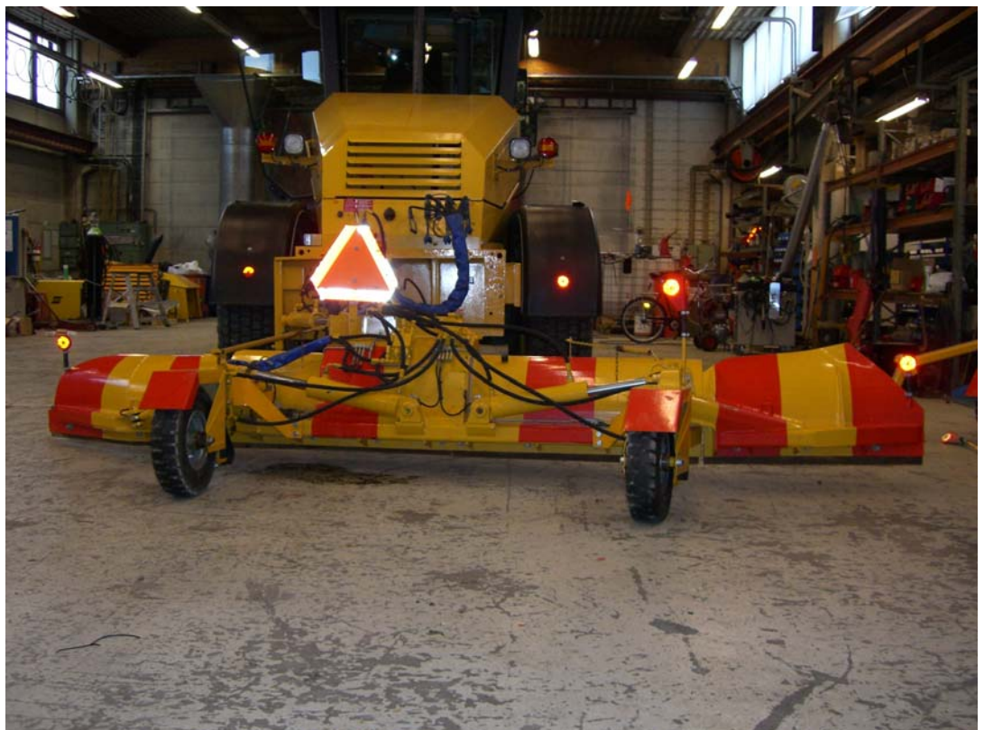
Kuva 23 Telirakenne korvattu kiinteillä pyöräripustuksilla
