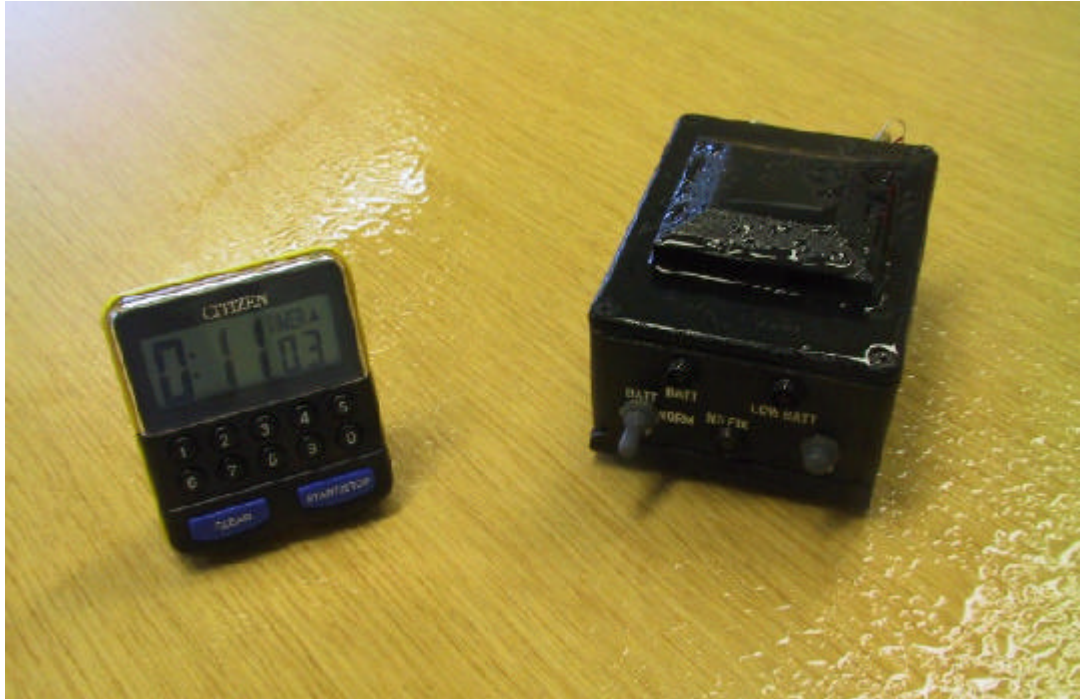
Kuva 16 GPS LOGGER Tiiveystestauksessa
