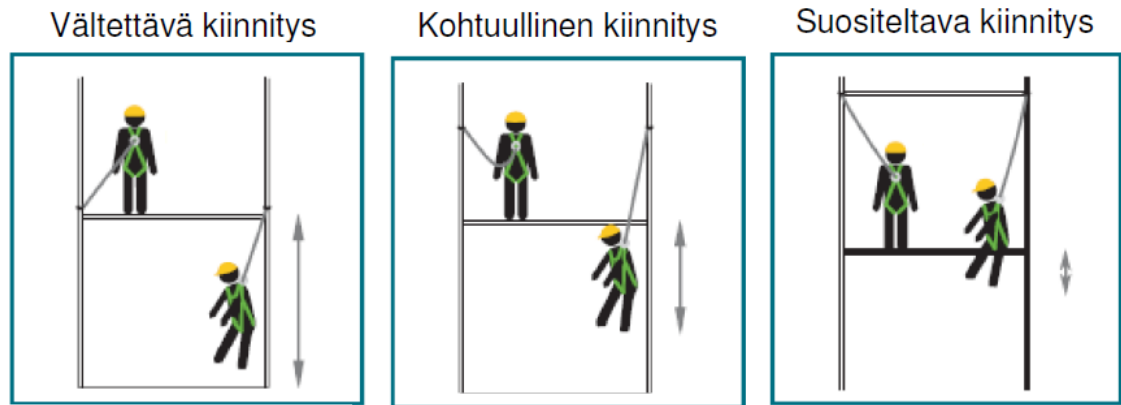
Kuva 5. Valjaiden kiinnitys [22, s.13]
