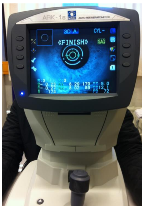
Kuvio 11. Autorefraktio- ja keratometrimitaus Nidek ARK-1s -laitteella.
