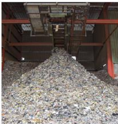
Kuva 17. Energiajätteen murskauslaitokselta muodostuva kiinteä kierrätyspolttoaine SRF. (Kuva: N. Riihisaari)
