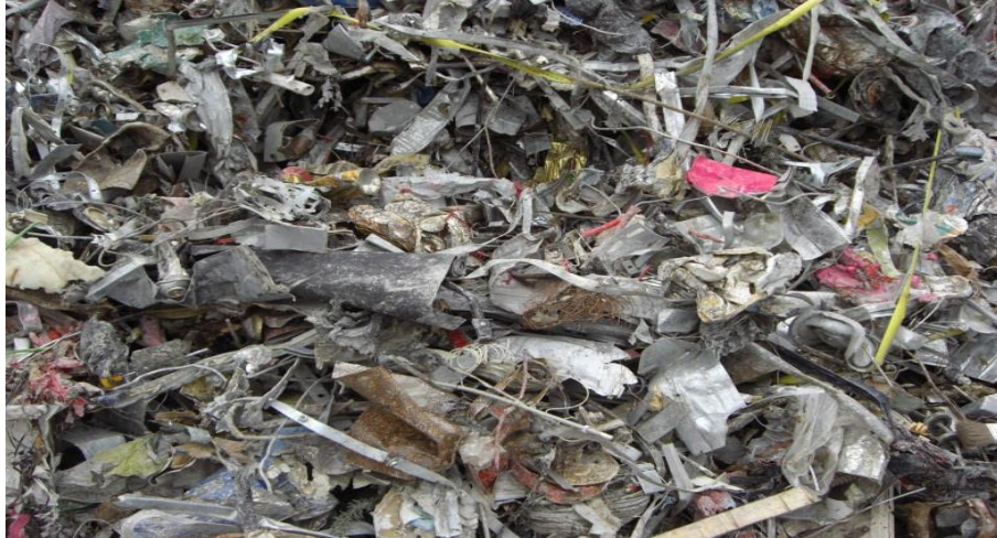
Kuva 13. Lajitteluprosessissa erottuneita metalleja. (Kuva: N. Riihisaari)
