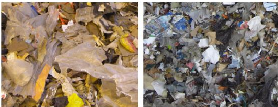
Kuva 15. 2D-jae ja 3D-jae. (Kuva: N. Riihisaari)
