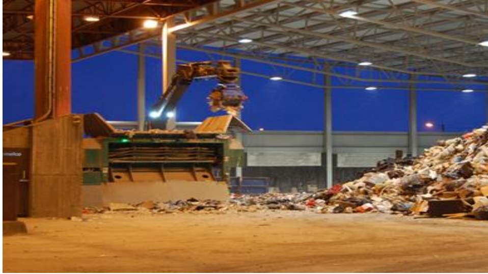
Kuva 11. Kahmari syöttämässä jätettä murskaimeen. (Kuva: A. Sironen)
