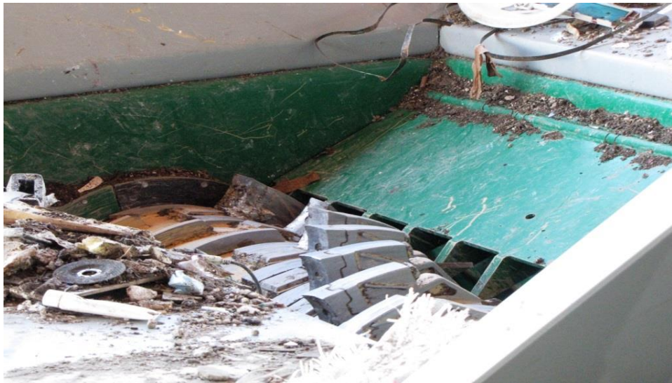
Kuva 12. Murskaimen (Terminator) telat hienontavat jätettä prosessille sopivaan palakokoon. (Kuva: A. Sironen)
