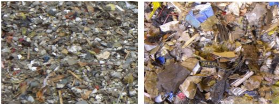
Kuva 14. Ballistorin seulomat 0–30 mm jae ja 30–80 mm jae. (Kuva: N. Riihisaari)
