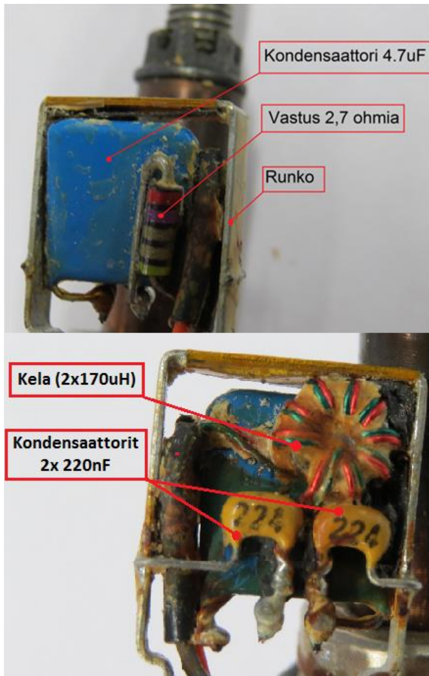
KUVA 4. RFI-filtterin rakenne sekä komponentit
