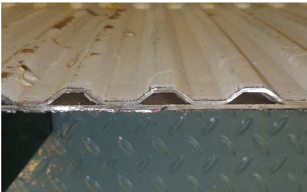
LVI-kuva 9. Ensimmäisen kerroksen vessasta otetun patterin katkaisu.
