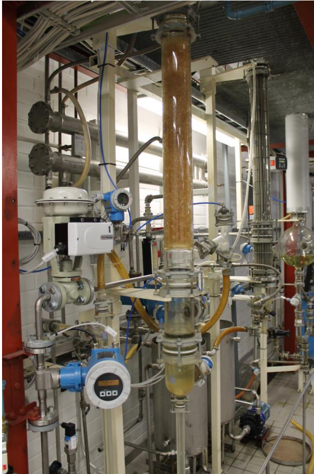
KUVIO 2. Työssä käytetyn laitteiston Raschig-renkailla täytetty absorptiokolonni
