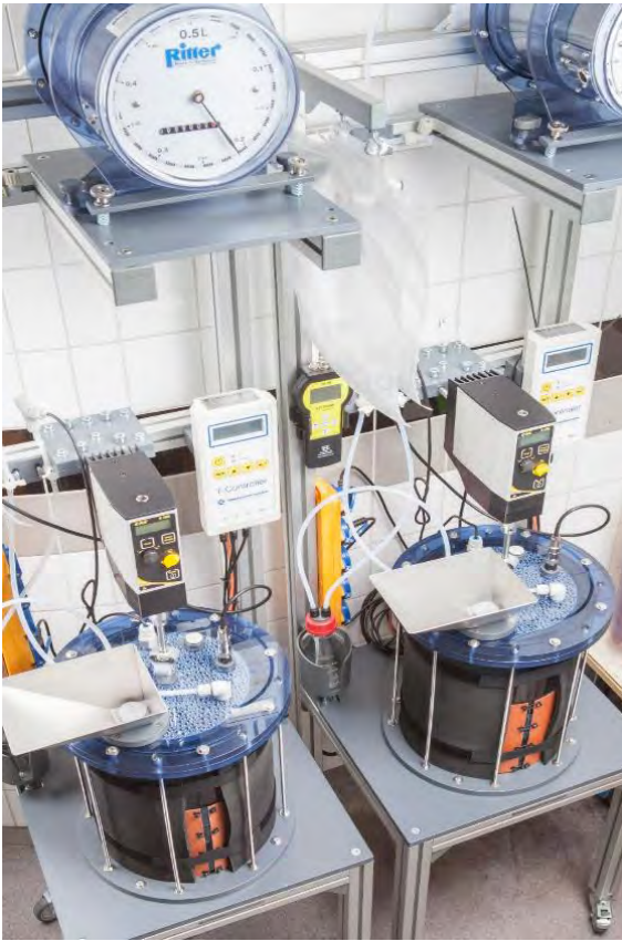
Kuva 2. Jatkuvat toimiset biokaasureaktorit (Kuva Manu Eloaho)
