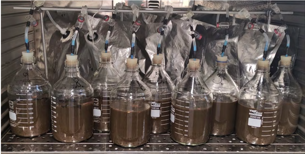
Kuva 1. Biokaasupanosreaktorit lämpökaapissa yhdistettynä kaasunkeräyspusseihin (kuva Tiina Saario)
