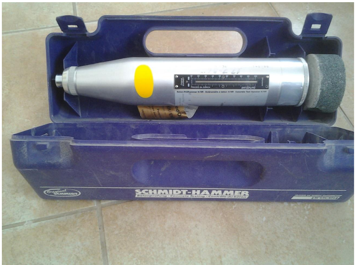
Kuvio 14. Testeissä käytetty kimmomasara
