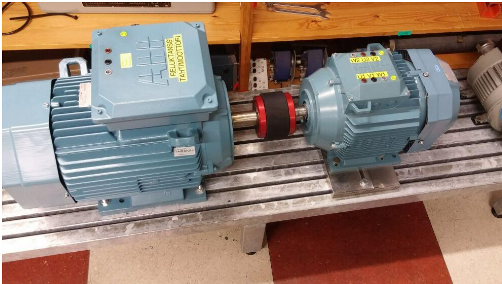
Kuva 6. Mittauksissa tahtireluktanssimoottori kytkettiin tähteen ja oikosulkumoottori kolmioon.
