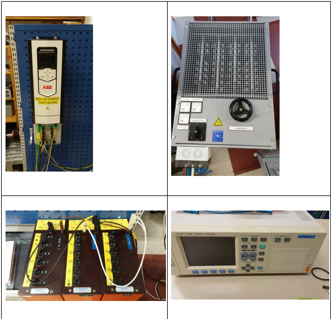
Kuva 7. ACS880 -taajuudenmuuttaja sekä muita laitteita.
