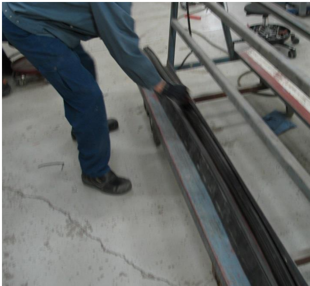
KUVA 14. Saippualiuoksen levitys tiivisteeseen (Fokor 2015)
