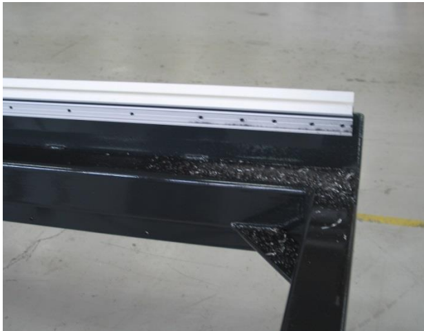
KUVA 11. Luukun kiinnitysreikien poraus peräkehään (Fokor 2015)
