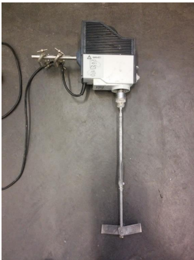
Kuva 13. Moottorisekoitin Heidolph RZR 2041 (Ollikainen 2014-12-11) (Rae.savonia.fi.)
