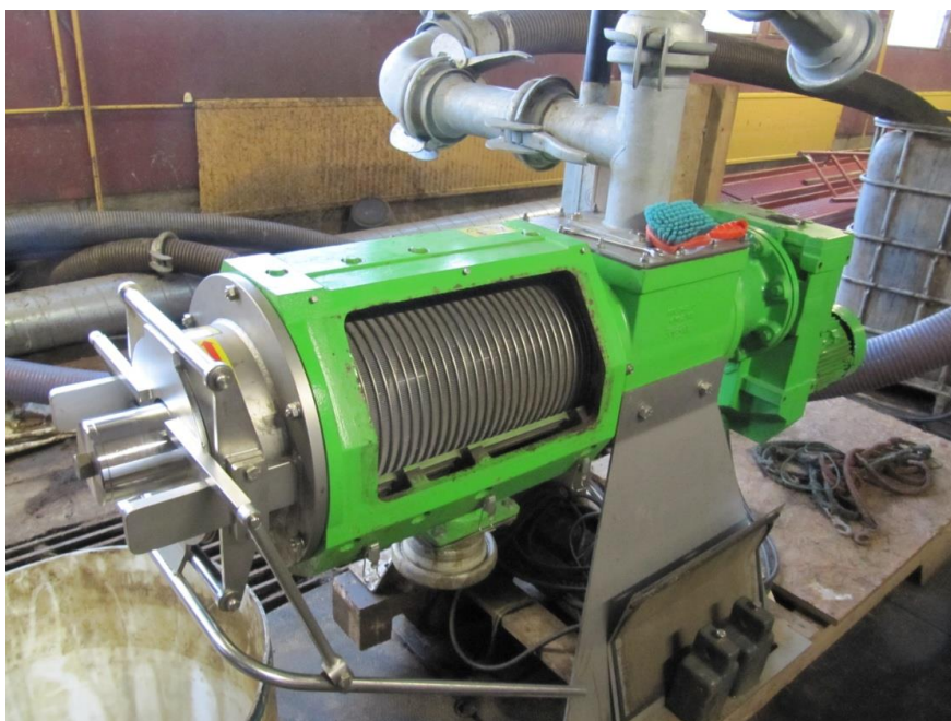
Kuva 15. Mekaanisessa separoinnissa käytetty ruuvipuristin (Ollikainen 2015-01-14) (Rae.savonia.fi.)
