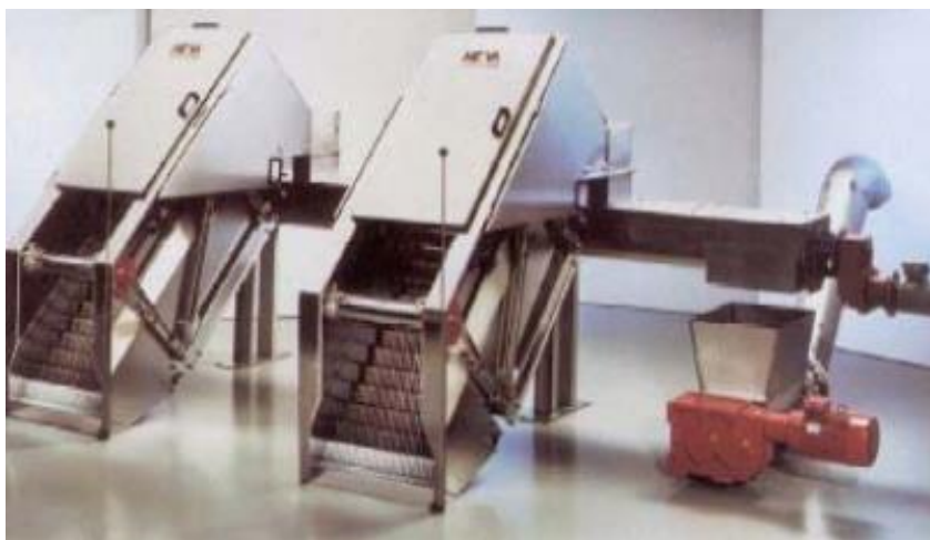
Kuva 8. Porraskuljettimella varustettu kanavaseula (afbini.gov.uk)
