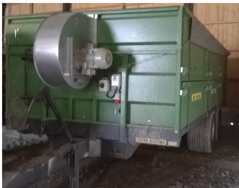
Bild 6. Släpvagnstork med fastmonterad fläkt (Foto: Patrik Lindblad)
