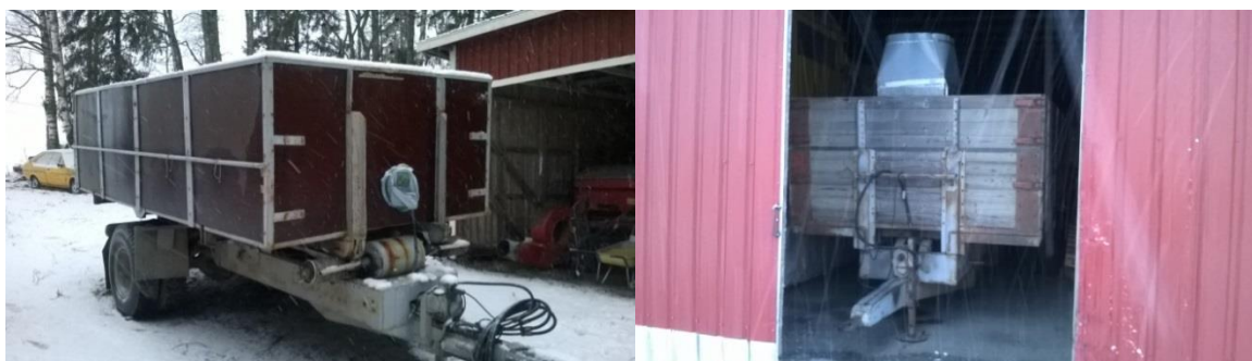
Bild 4. Släpvagnstork med lastväxlarfunktion Bild 5. Släpvagnstork med luftintag upptill (Foto: Patrik Lindblad)
