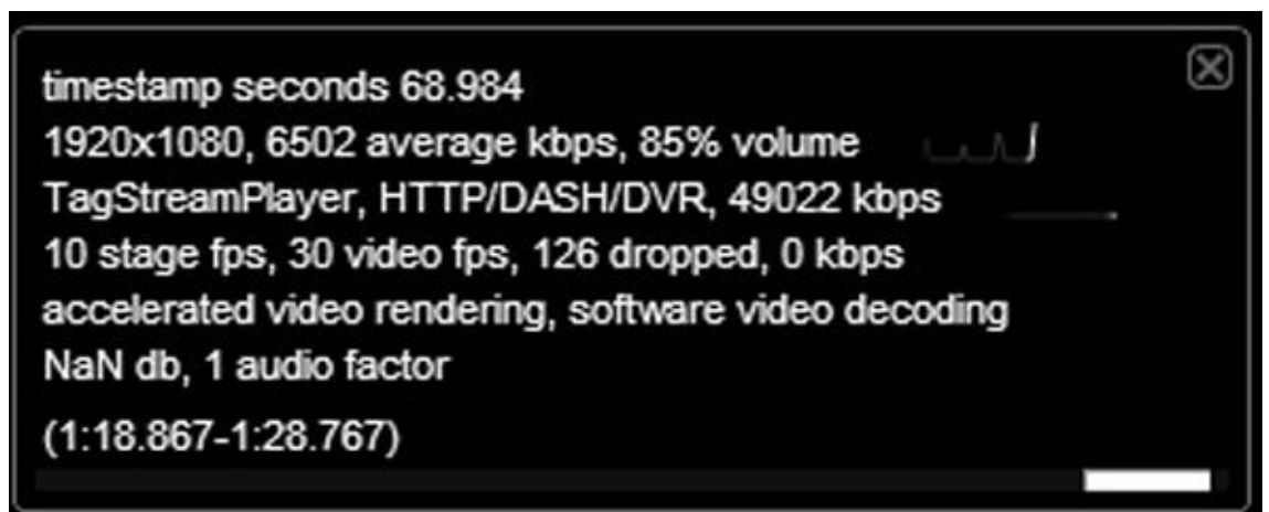
Kuva 1. Tilastoja YouTube'n kautta tehdystä live-streamistä. Kuvassa näkyy että YouTube käyttää MPEG DASH-tekniikkaa sekä muita teknisiä ominaisuuksia streamistä.
