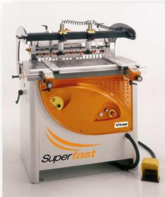
Kuva 12. Monikaraporakone reikien poraamiseen (Eurotechin tuotesivut 2015)
