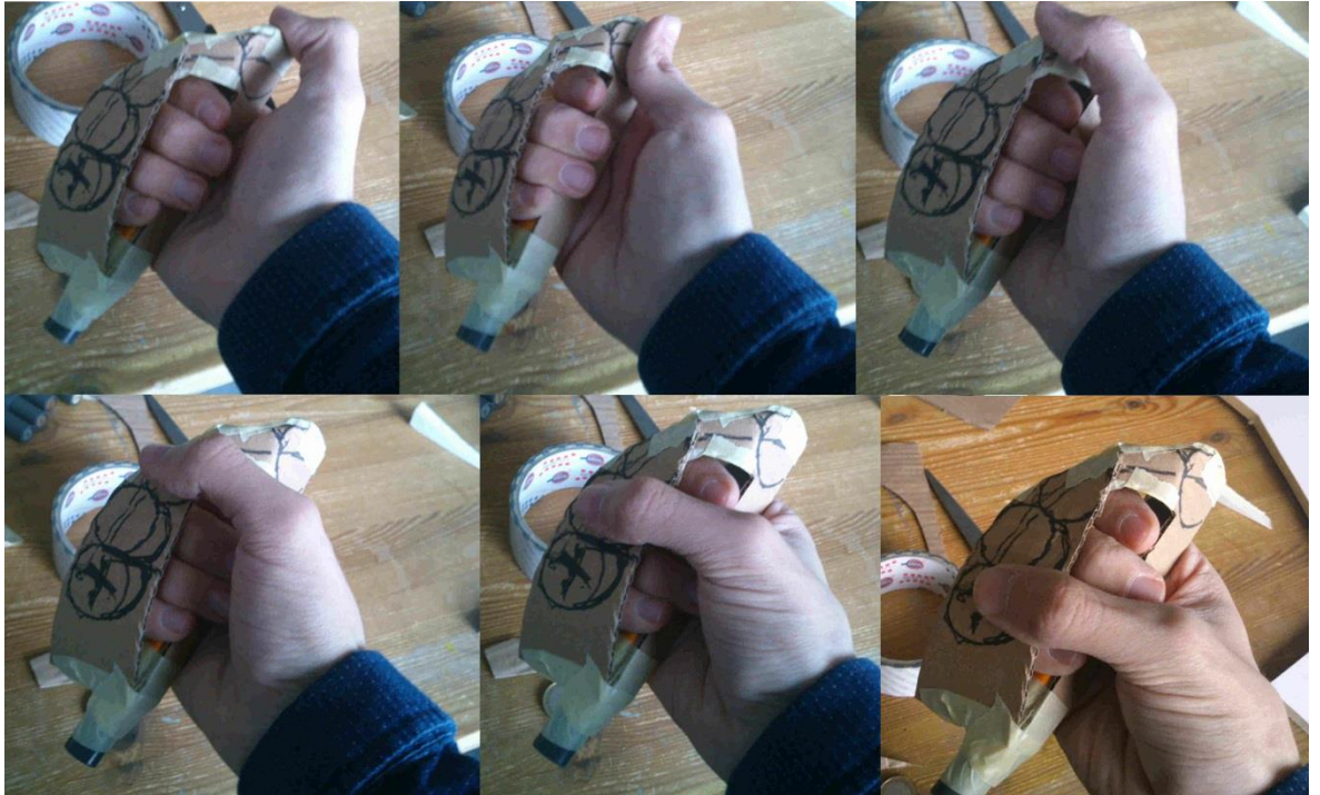
Kuva 26. Pahvimalli ja peukalon liikutus testaus. Aktivointi ja napit 1-5.
