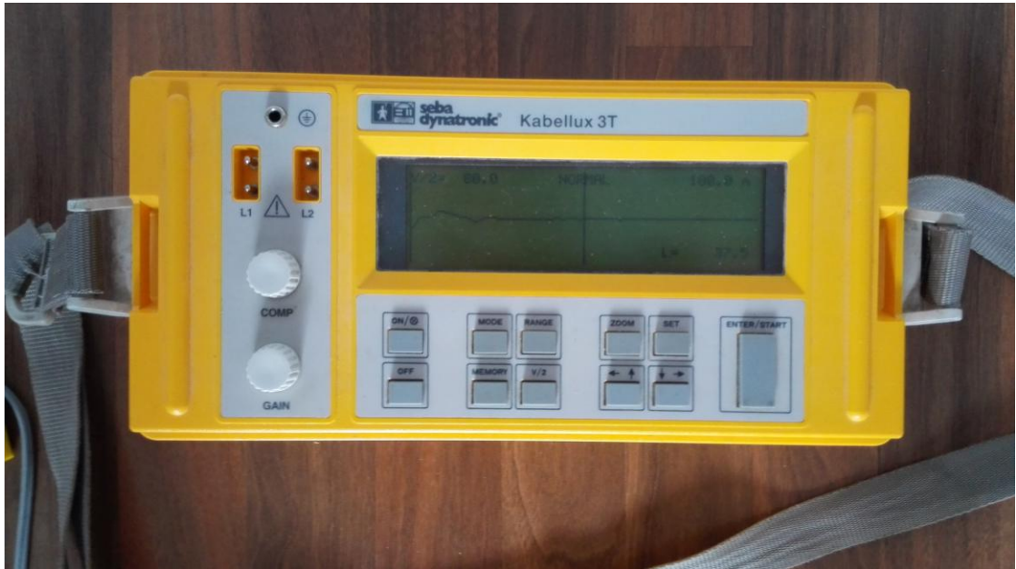
KUVA 15. Seba-Dynatronic Kabellux 3T -mittauslaite
