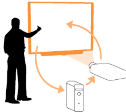
Kuvio 3 Miten taulu, tietokone ja projektori toimivat yhteistyössä (SMART Board ratkaisuja 2007).
