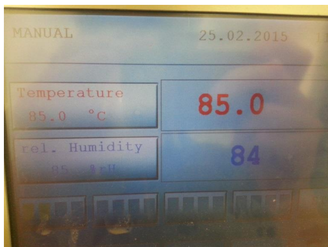
KUVA 8. Testiolosuhteet olosuhdekaapissa (Pasanen 2015-02-25)
