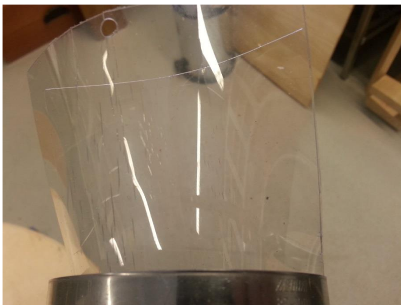
KUVA 11. Taivutetun Lexan FR60:n säröilyä (Pasanen 2015-03-09.)
