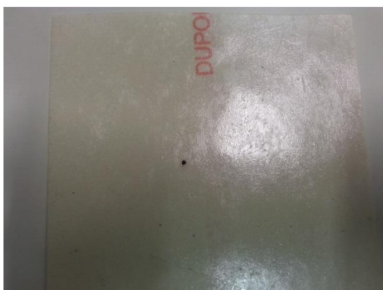
Kuva 64. Nomex 0.2mm läpilyönnin jälki (Pasanen 2015-02-20)
