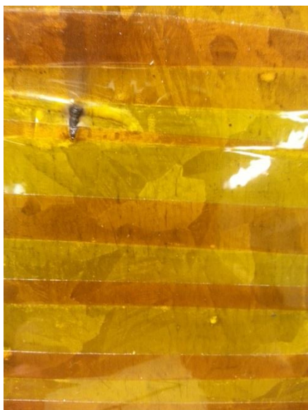
KUVA 9. Kapton-eristeen läpilyönnin jäljet (Pasanen 2015-02-27.)
