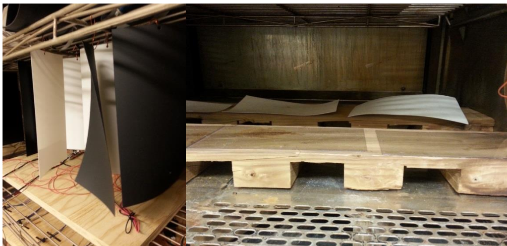
KUVA 10. Formex GK-17 (vasemmalla) ja Nomex 0,5mm (oikealla) kipristelyä (Pasanen 2015-03-03.)
