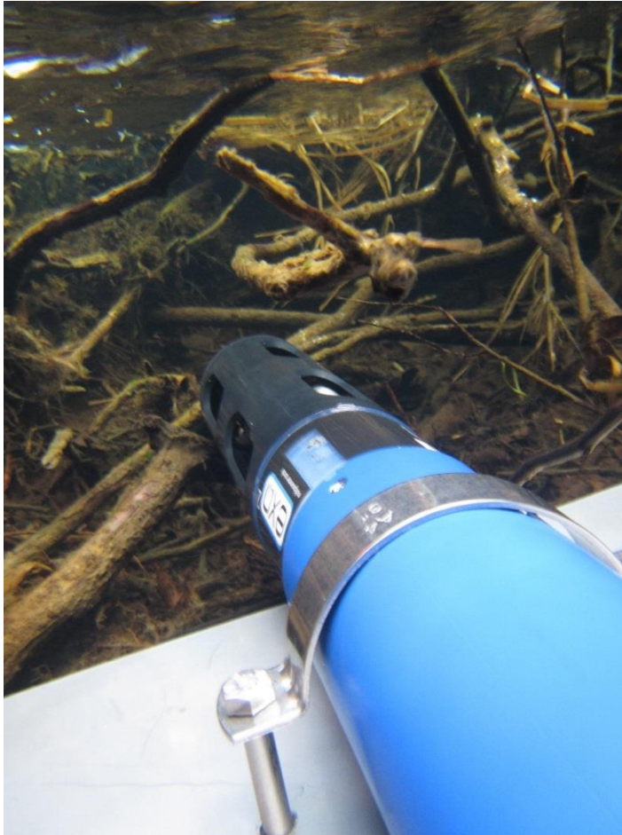
KUVA 9. YSI EXO2 -mittalaite asennettuna kuivatusvesien purku-uoman pohjalle. Mittaussensorit sijaitsevat laitteen mustassa etuosassa.
