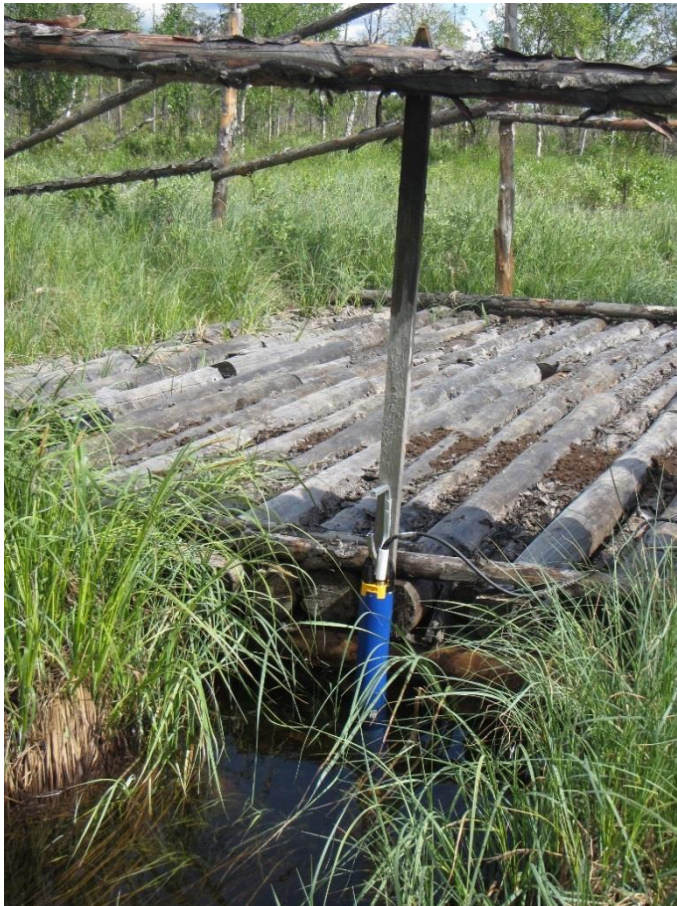
KUVA 4. YSI EX02 -mittalaite asennettuna prosessivesien purkuojaan.
