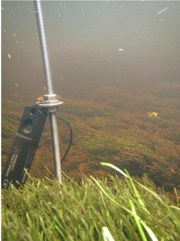
KUVA 3. Onset HOB0 U24 Conductivity Logger -sensori asennettuna Seurujokeen kaivoksen alapuolelle, Hobo2.
