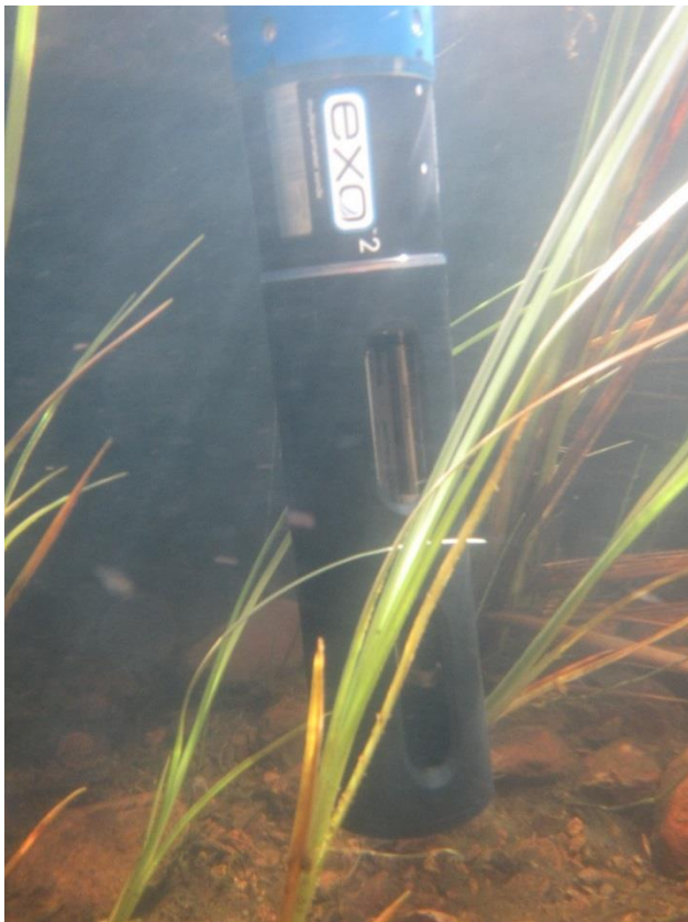
KUVA 6. YSI EXO2 -mittalaite asennettuna prosessivesien purkuojaan. Mittaussensorit sijaitsevat laitteen mustassa alaosassa.
