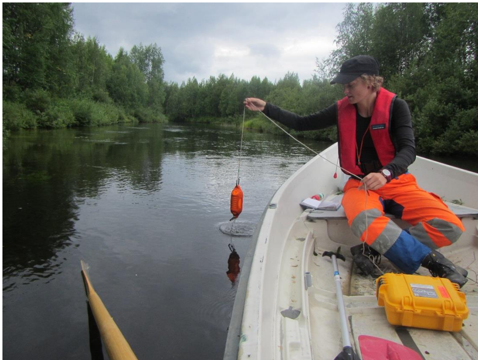
KUVA 10. CastAway CTD -mittalaite käytössä Seurujoella kesällä 2013. (Kuva: GTK, 2013.)
