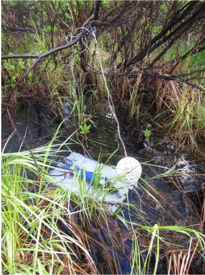
KUVA 7. YSI EXO2 -mittalaite asennettuna kuivatusvesien purku-uomaan.
