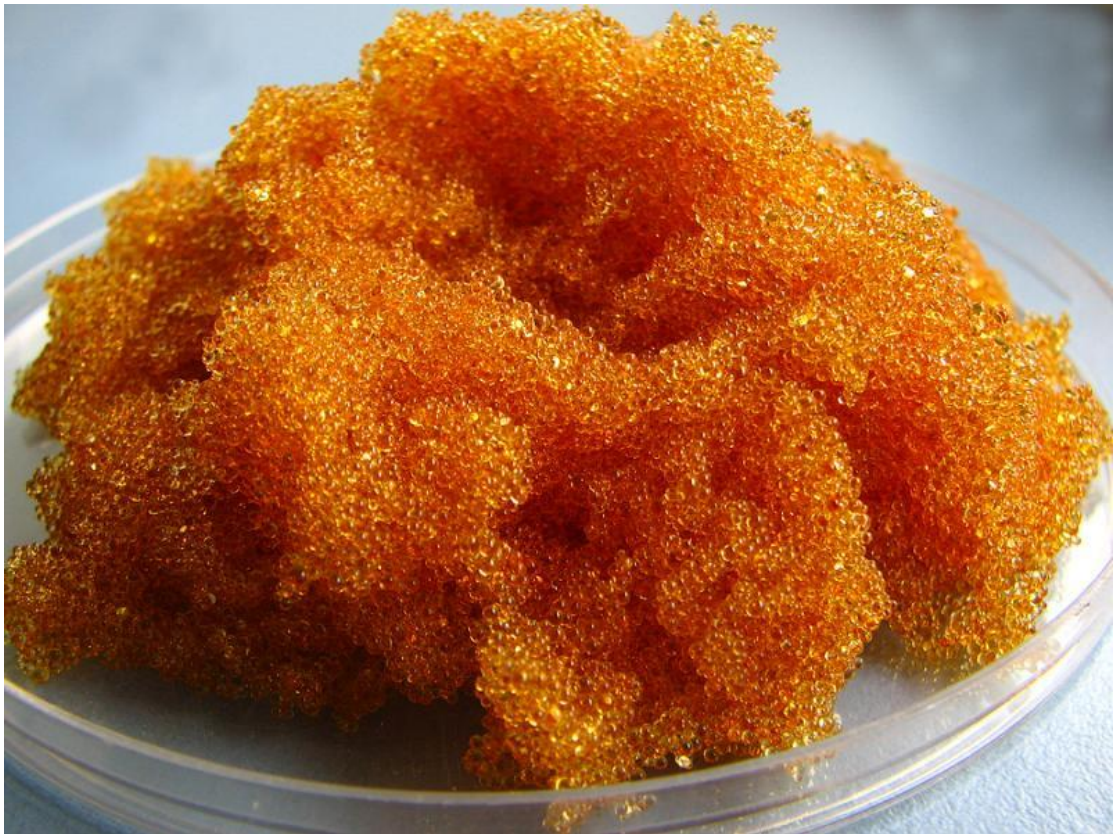
Kuva 16: Ioninvaihdossa käytettävää hartsimassaa [5]
