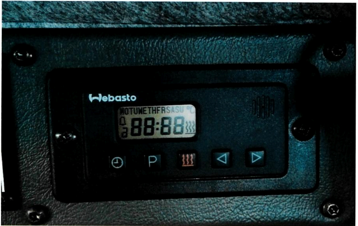
Kuva 7. Webasto-merkkisen esilämmittimen ajastinkello.
