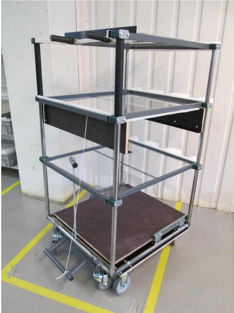
Kuva 23. Protokärryn neljä hyllytasoa tukevat omilla ominaisuuksillaan monimuotoisten materiaalien kuljetusta.
