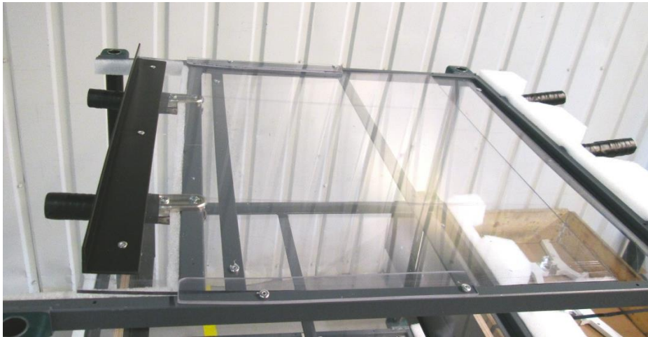
Kuva 20. Ylähylly liukuu yhtenäiseksi pinnaksi vasemmalla nähtävien tappien päälle. Musta L-muotoinen lista toimii vetokahvana.
