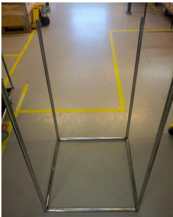
Kuva 10. Kärryn runko hitsattuna ja valmiina.
