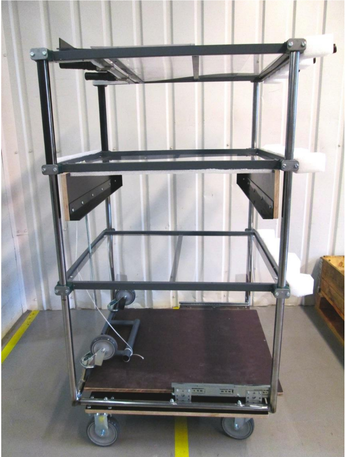
Kuva 17. Protokärry valmiina ja viimeisteltynä, naru kiikun laskemista varten näkyy kuvassa vasemmalla.
