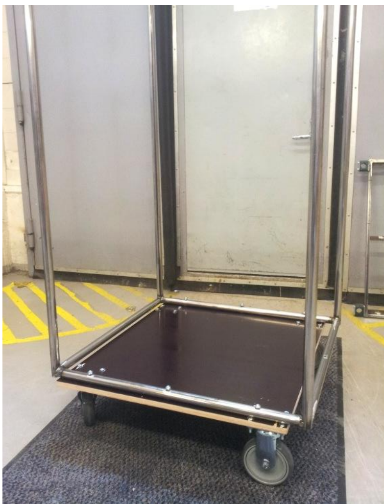
Kuva 11. Runkorakenne pohjalevyn päälle asennettuna.
