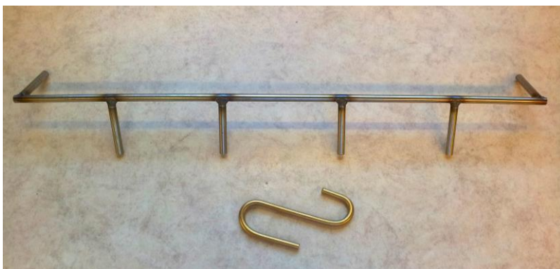
Kuva 22. Kärryyn liitettäviä koukkuja helpottamaan erikoisten materiaalien kuljetusta.
