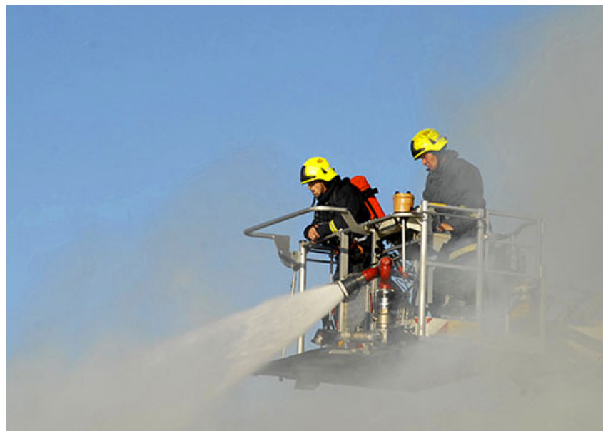
Kuva 7. Nostolavasta saadaan suihkutettua vettä suoraan kohteeseen yläpuolelta. ( http://www.turku.fi/public/default.aspx?nodeid=16840 ).
