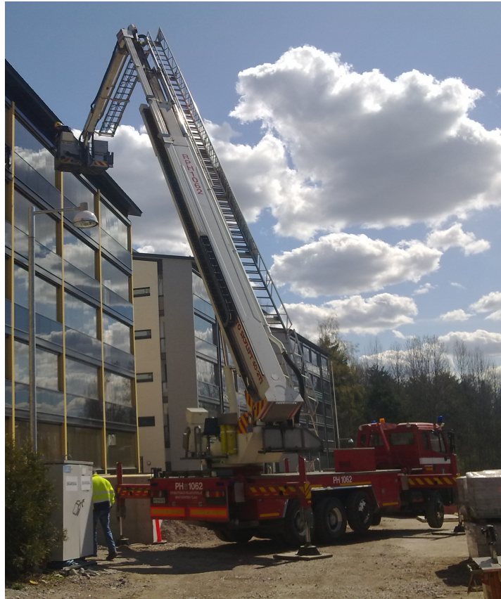
Kuva 8. Pelastustiekokeilu vanhemmalla nostolavalla F42HDT (Päijät-Hämeen pelastuslaitos).
