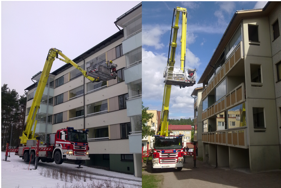
Kuva 10. Pelastustiekokeiluja uudemmalla nostolavalla F44RLXer (Päijät-Hämeen pelastuslaitos).
