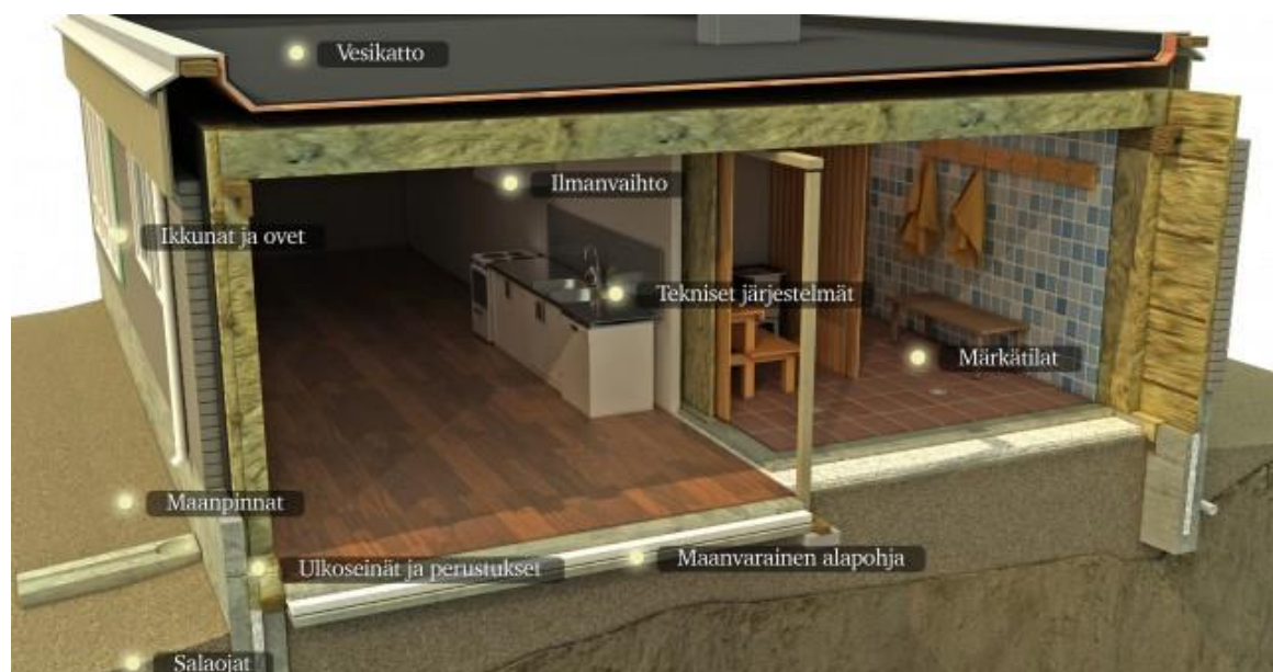
Kuva 15. Riskirakenteiden sijainnit (Hometalkoot.fi/kosteus- ja hometalkoot)
