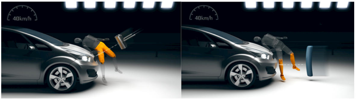
Kuva 18 Jalkoihin kohdistuvat kokeet (Euro NCAP)
