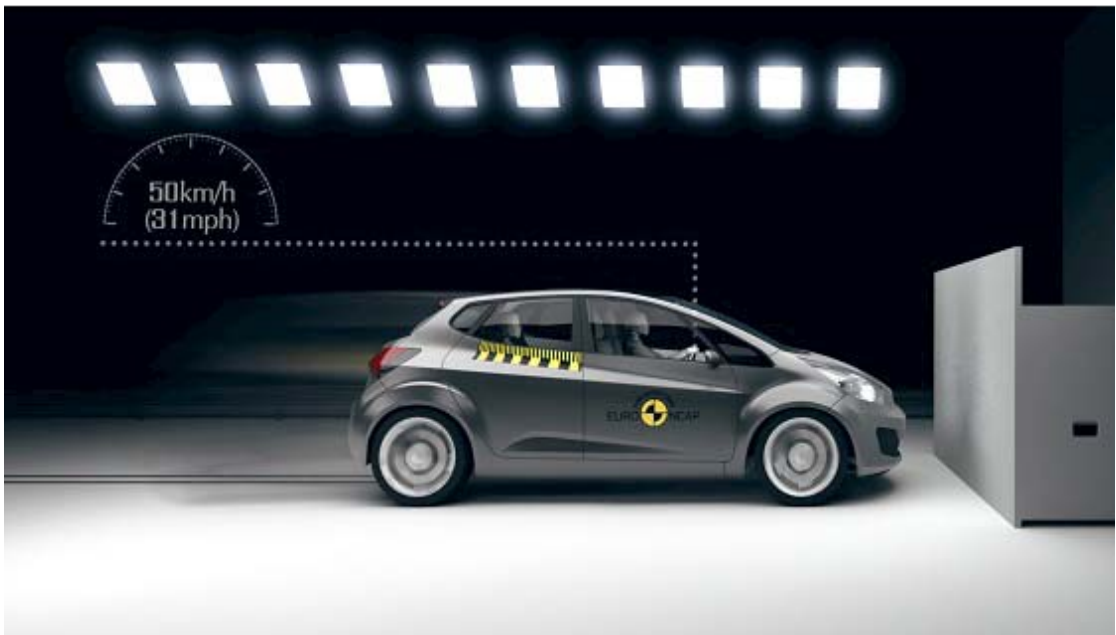
Kuva 11 Suora törmäyskoe (Euro NCAP)
