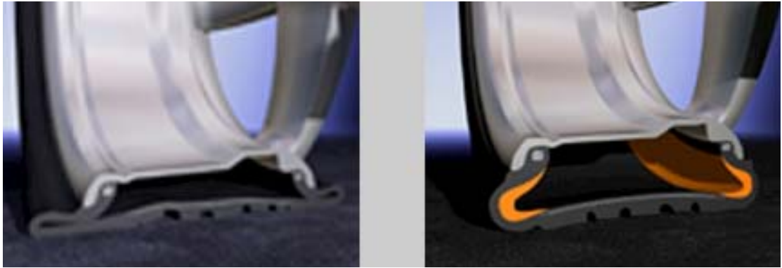
Kuva 9 Sivuseinämävahvistettu runflat rengas (Continental)
