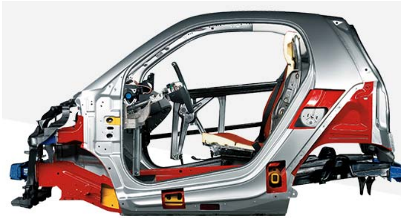
Kuva 2 Smartin Tridion rakenne (Daimler)
