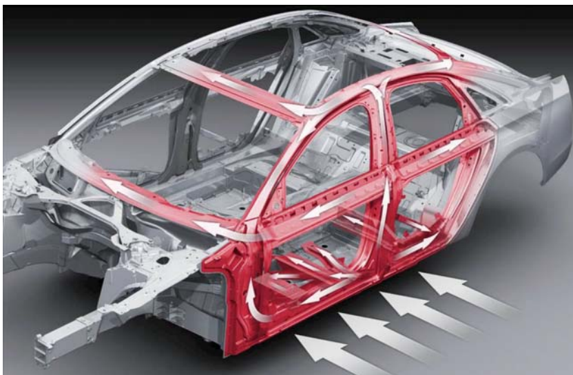
Kuva 3 Audi Space Framen törmäysvoimien kulkeutuminen (AUDI AG)
