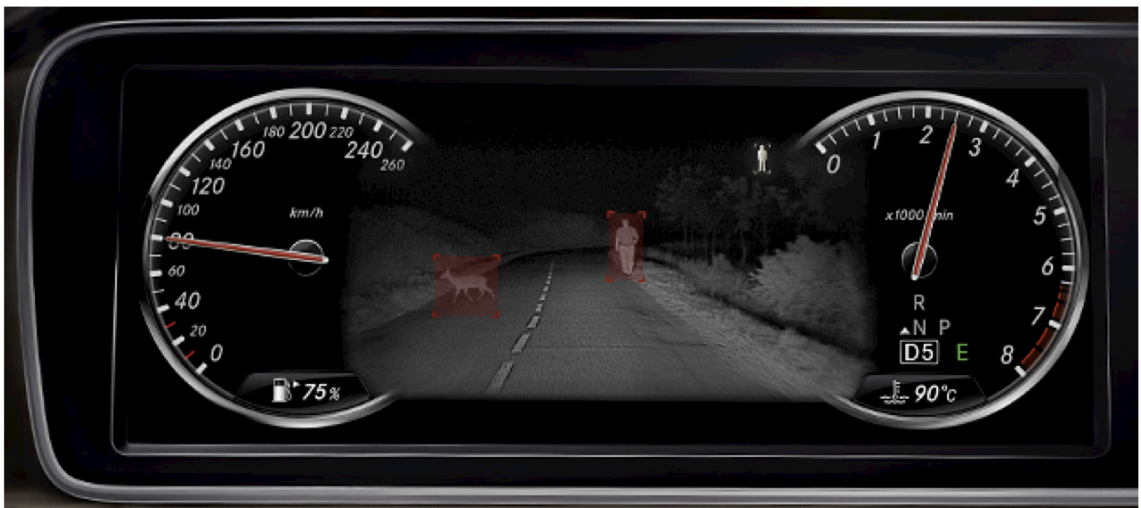
Kuva 20 Mercedes-Benzin pimeänäköavustin (Mercedes-Benz)
