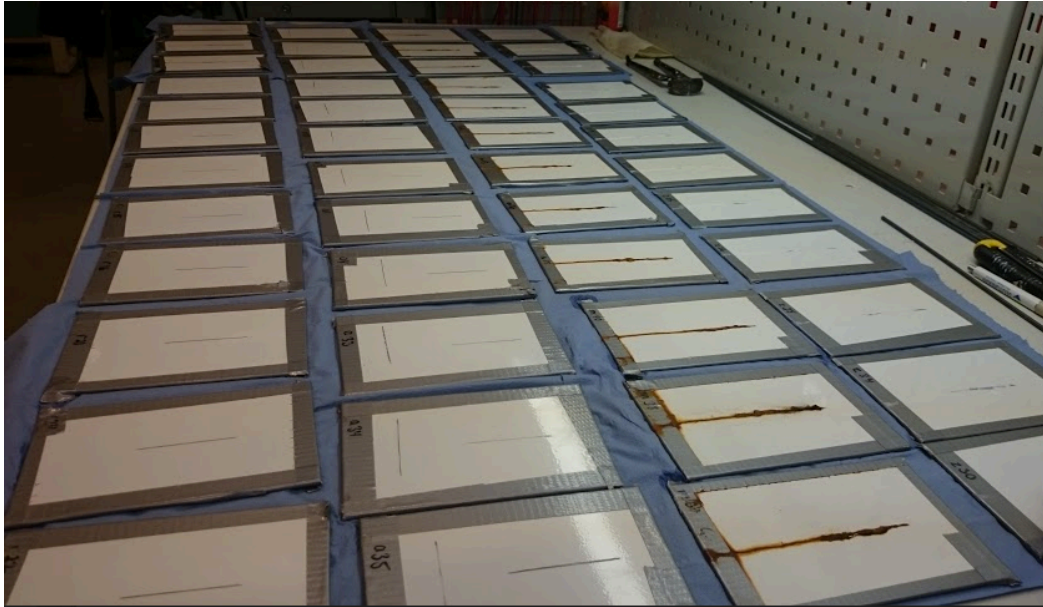
Kuva 10. Suolasumukaapista tulleet koekappaleet huuhdeltiin ja tarkastettiin ensin silmämääräisesti.
