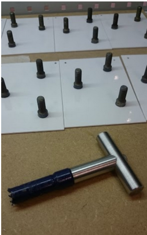
Kuva 9. Ylimääräinen liima poistettiin vetonuppien ympäriltä käsiporalla.
