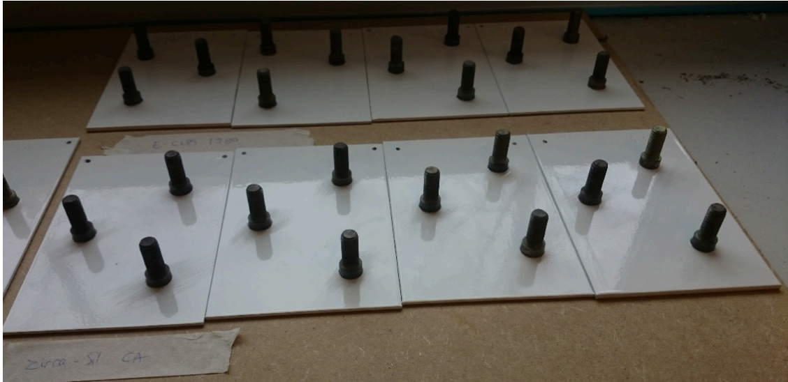
Kuva 8. Koekappaleita valmiina vetokokeeseen.
