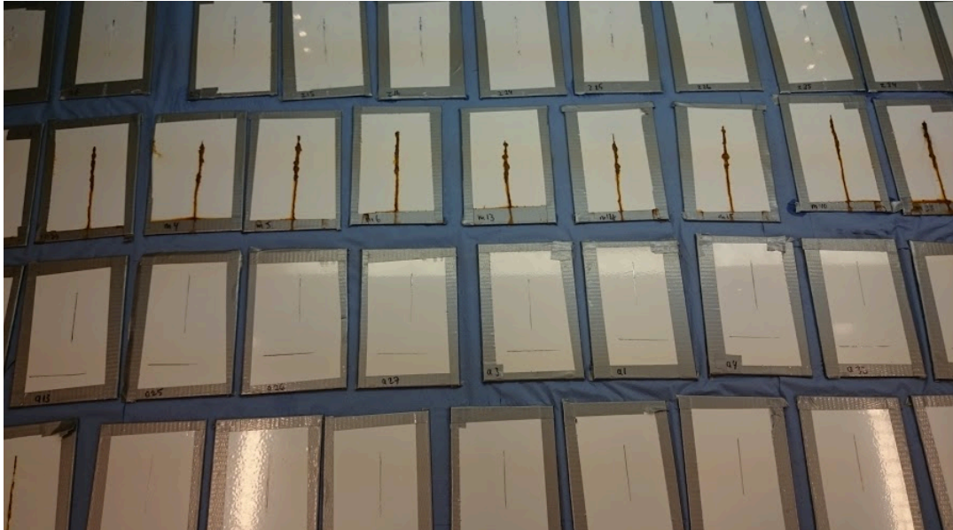
Kuva 1. Koekappaleissa oli havaittavissa eroja korroosiorasituksen jälkeen.
