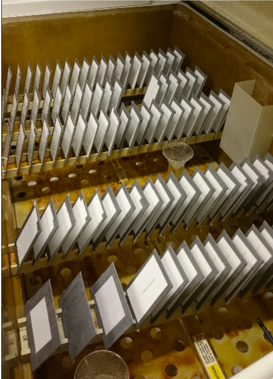
Kuva 5. Koekappaleet suolasumukokeessa. Välitarkastus.
