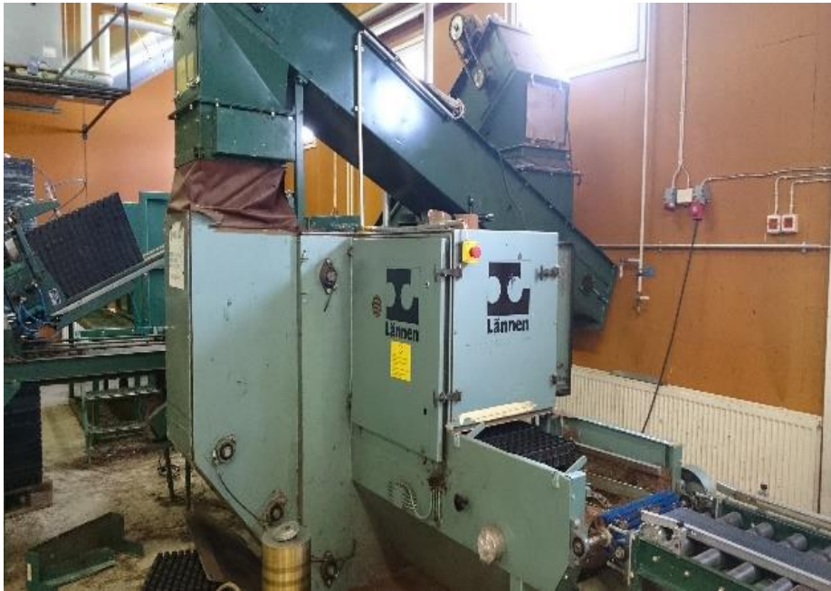
Kuvio 10. Turpeen täyttö- ja tiivistyskone
