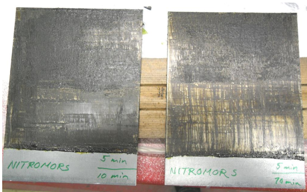
Kuva 11. Koekappaleet poistokokeen jälkeen. Oikean puoleiseen lisätty maalinpoistoainetta.
