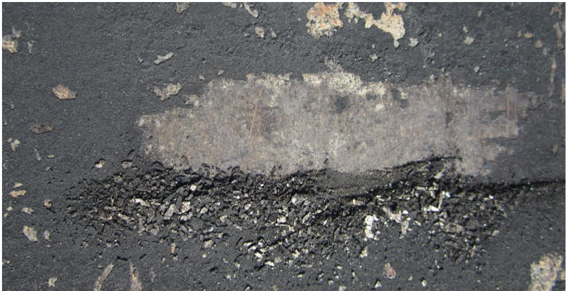
Kuva 5. Kattopellin pinnasta irti kaavittua pinnoitetta.
