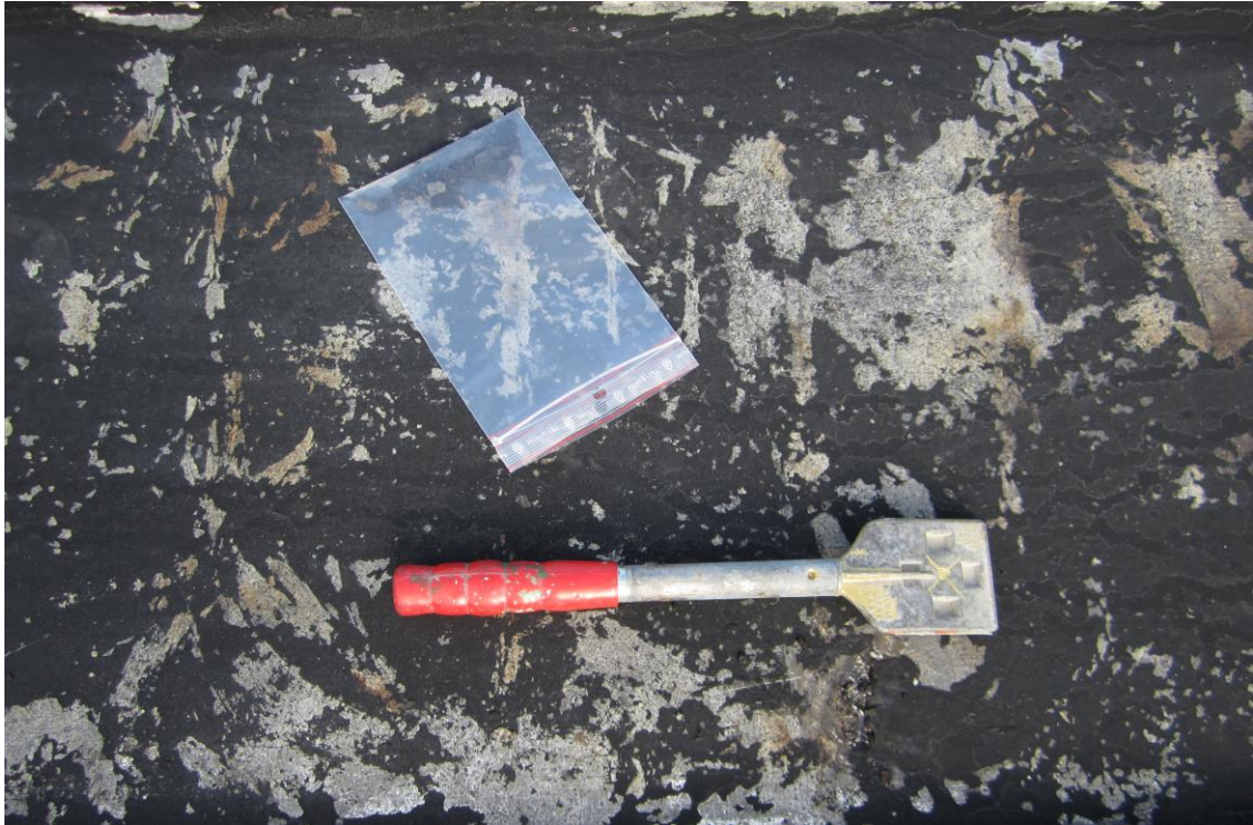
Kuva 6. Pinnoitteen poistoon käytetty kaavin ja pussi näytettä varten.
