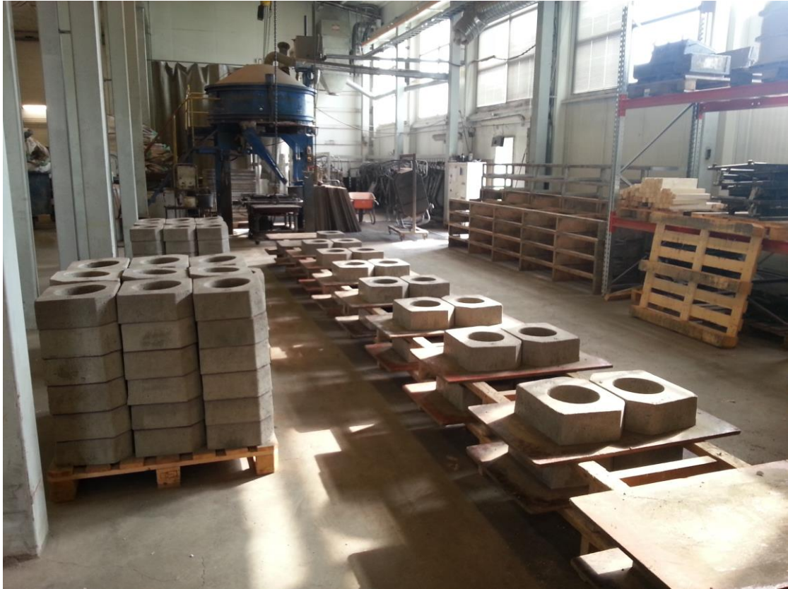
KUVIO 9. Bet-Ker Oy:n valuhallin kääntöpöydän valu- ja kuivumisalue.
