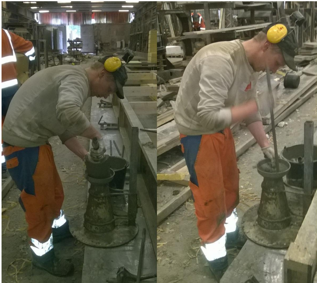
Kuvio 6. Painumakoeartion täyttäminen sullomistekniikalla.
