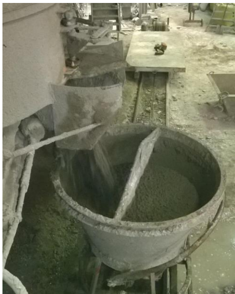
Kuvio 1. Betonin pudottaminen sekoittimesta kuljetusastiaan.
