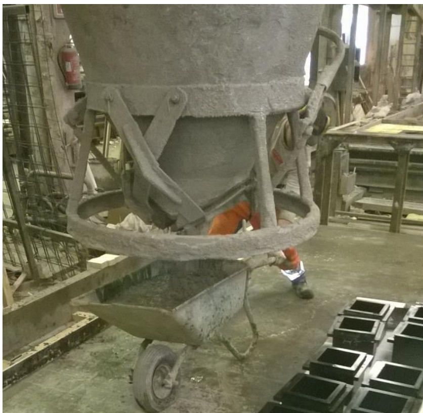
Kuvio 4. Edustava näyte betonimassasta laboratoriotutkimuksia varten.
