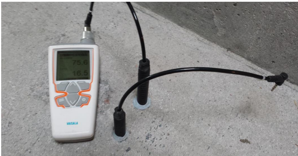
Kuva 41. Suhteellisen kosteuden mittaus poratuista reijistä.
