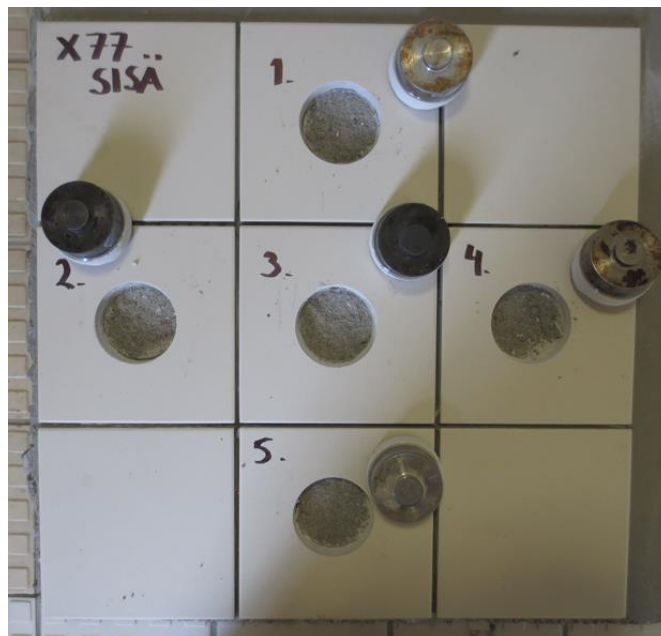
Kuva 45. Testikappale 2. Sementtikiinnitys sääsuojan sisällä. Kaikki murtumat tapahtuivat betonin sisäisenä murtona.
