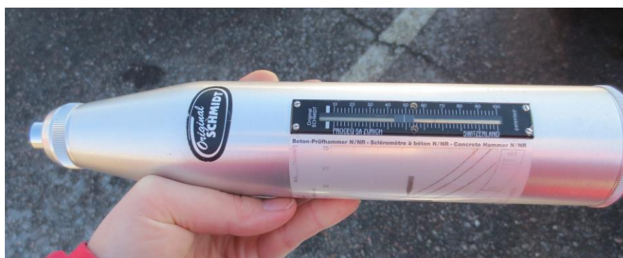
Kuva 39. Puristuslujuuden mittaamiseen käytettiin betonin testaamiseen tarkoitettua Original Schmid –kimmo-vasaraa.
