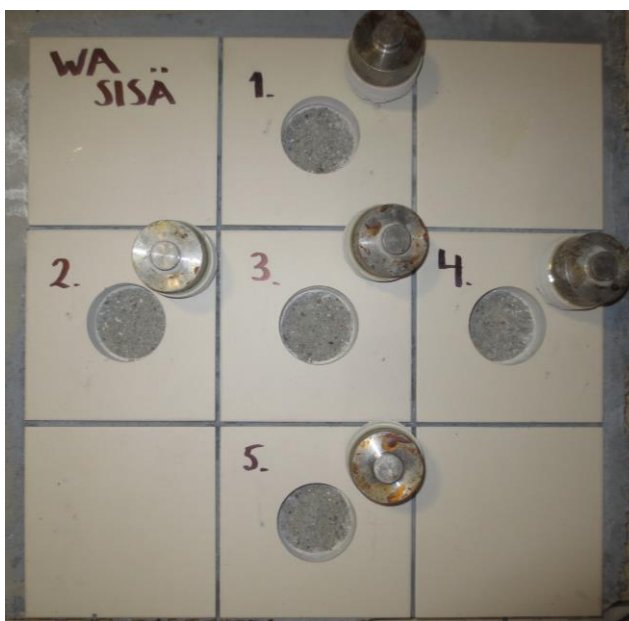
Kuva 44. Testikappale 1. Epoksikiinnitys sääsuojan sisällä. Kaikki murtumat tapahtuivat betonin sisäisenä murtona.
