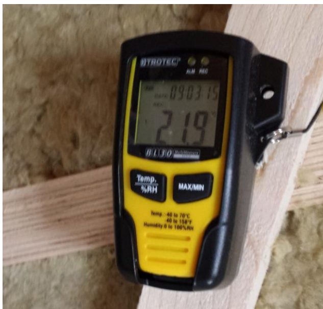
Kuva 33. Ilman lämpötilan ja kosteuden mittaamisen käytetty mittauslaite. Trotec BL 30 lämpötila- ja kosteusloggeri.
