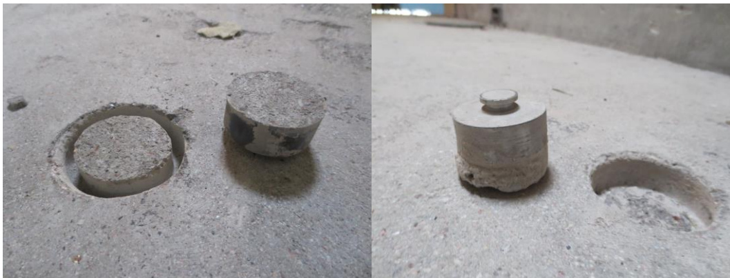
Kuva 38. Kuvassa vasemmalla vetokoekiekkko, jonka liimaus on pettänyt. Oikealla onnistuneesti suoritettu vetokoe.
