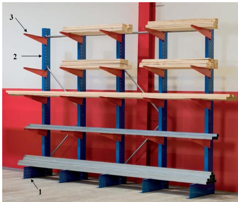
KUVIO 8. Yksipuolinen ulokehylly, osien nimitykset 1) Runkopylvään tukijalka, 2) Runkopylväs, 3) Uloke (Hyllymix Oy)
