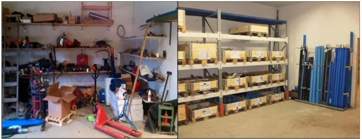
KUVIO 12. Vasemman puoleisessa kuvassa A- sektorin tila ennen uudistusta, oikeanpuoleisessa kuvassa uusi kuormalavahyllykkö ja jatkokarojen teline
