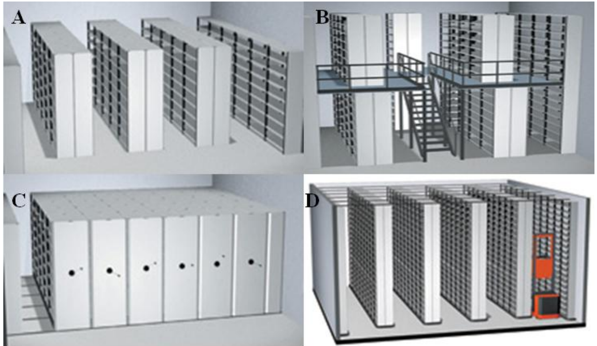
KUVIO 4. Pientavarahylllystöjen tilankäyttö, A on perinteinen pientavarahyllly, B kerroshyllly, C siirtohyllly, D kapeakäytävähyllly (Intolog Oy 2014)
