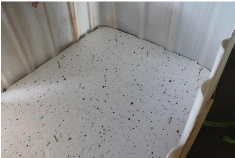
Kuvio 13. EPS-eristelevy raudoituksineen pienoismallissa.
