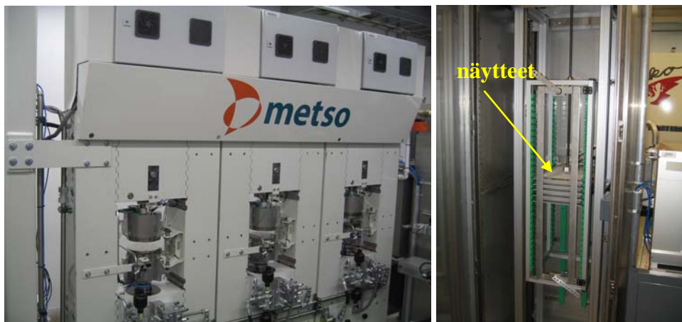
Kuva 7. Kuormakehät NK 1-3 (vasemmalla) ja olosuhdekaappi NK 1 (oikealla).
