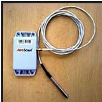
Kuvio 7. Esimerkki semi-aktiivisestä RFID-tunnisteesta (Floyd 2014)
