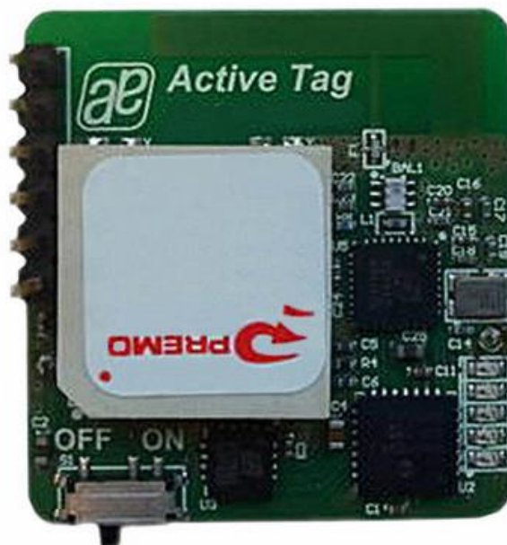
Kuvio 6. Esimerkki aktiivisesta RFID-tunnisteesta (RFID evaluation and development kits, boards 2015)
