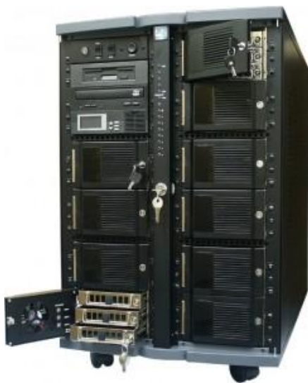
KUVIO 4. Esimerkki palvelinkaapista, johon on pinottu useita palvelintietokoneita (Server Computer 2014)
