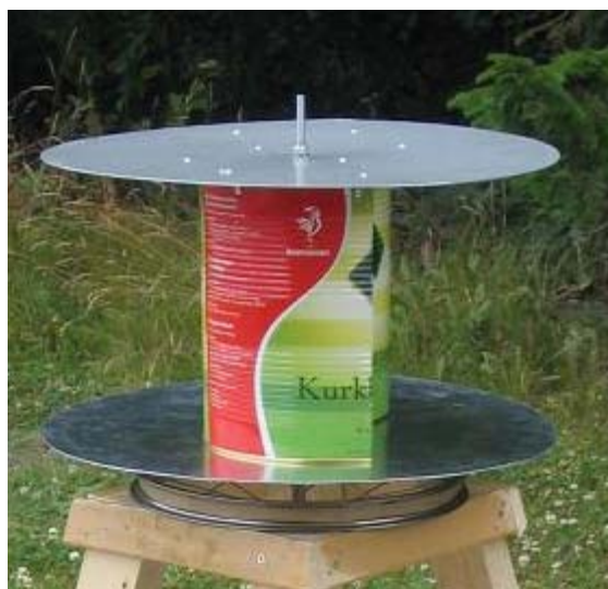
Kuva 10. Akseloitu ja laakeroitu Savonius-roottori.
