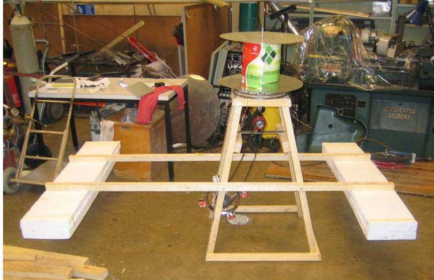
Kuva 24. Ilmastin aisojen nostamisen jälkeen.
