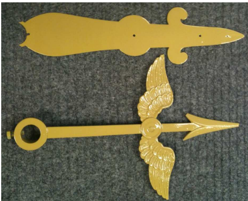
Kuva 27. Vasemmalla tuntiosoitin pohjamaalattuna ja aukaistuna. Kuva Raimo Snellman 2010.
