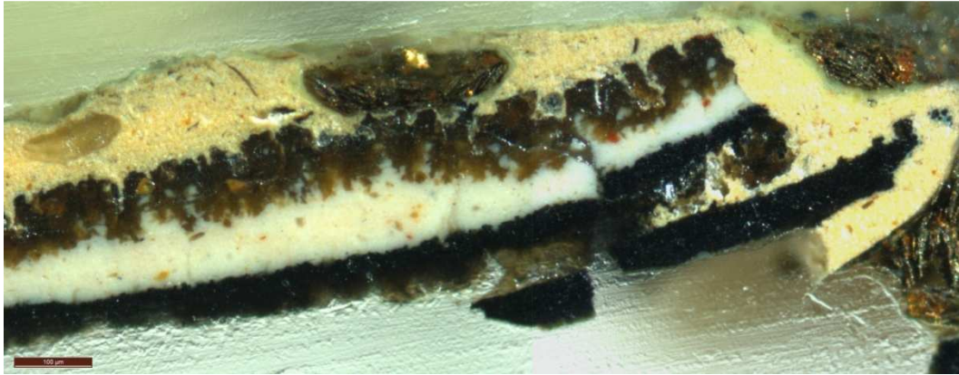
Kuva 17. Poikkileikkausnäyte VN1-13a kellotaulun ulkoreunasta.
