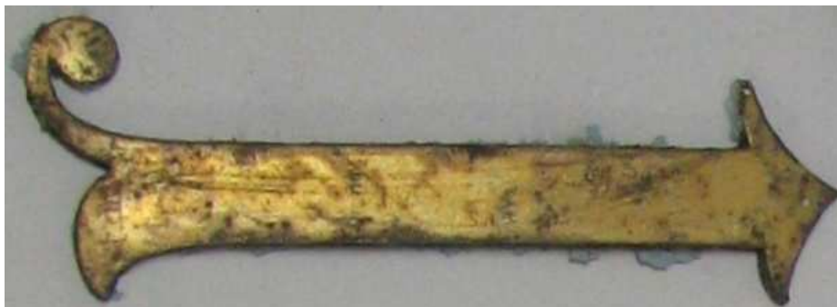
Kuva 23. Yksi VN1:n numero irrotettuna 20.10.2010. Numeroiden kultaus oli huonokuntoista.
