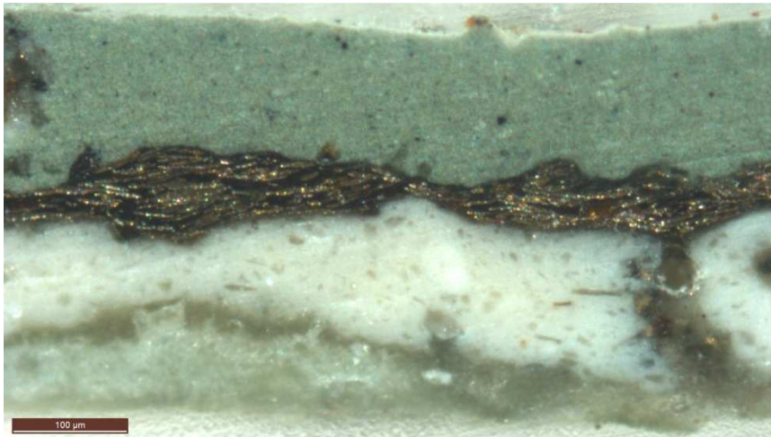
Kuva 20. Poikkileikkausnäyte VN1-14 sisemmän koristerenkaan sivulta.
