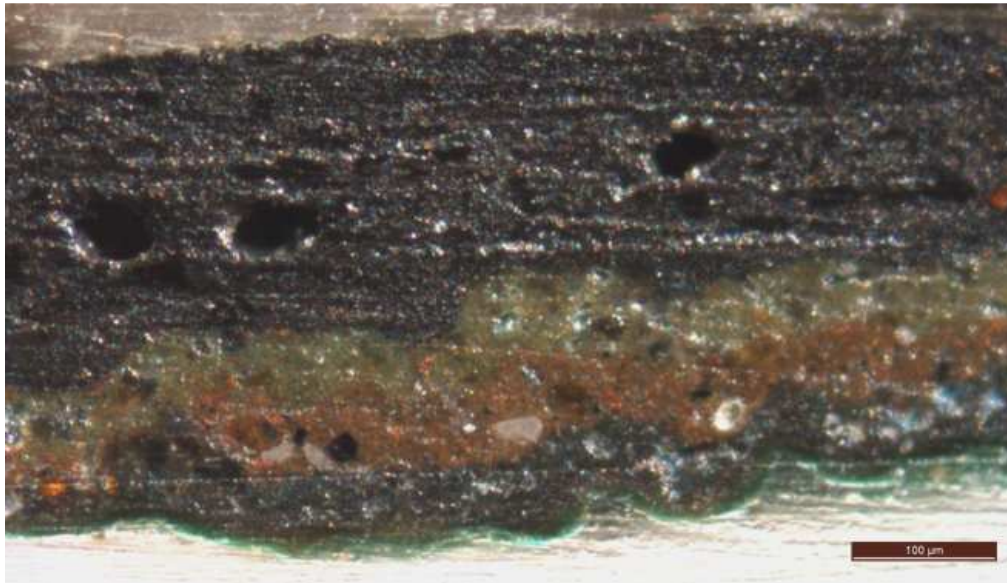
Kuva 5. Poikkileikkausnäyte VN1-1 mustasta kerroksesta numeroiden alta.
