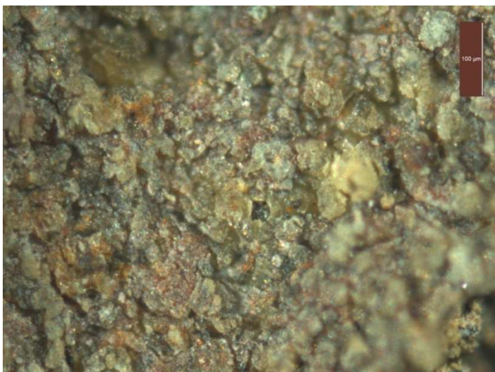
Kuva 52. VN1-13a kuparisen kellotaulun ulkoreuna yltä. Kohta on seinän läheltä.
