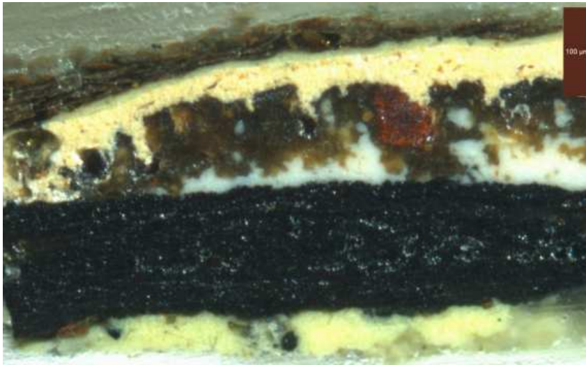
Kuva 18. Poikkileikkausnäyte VN1-13a kellotaulun ulkoreunasta.
