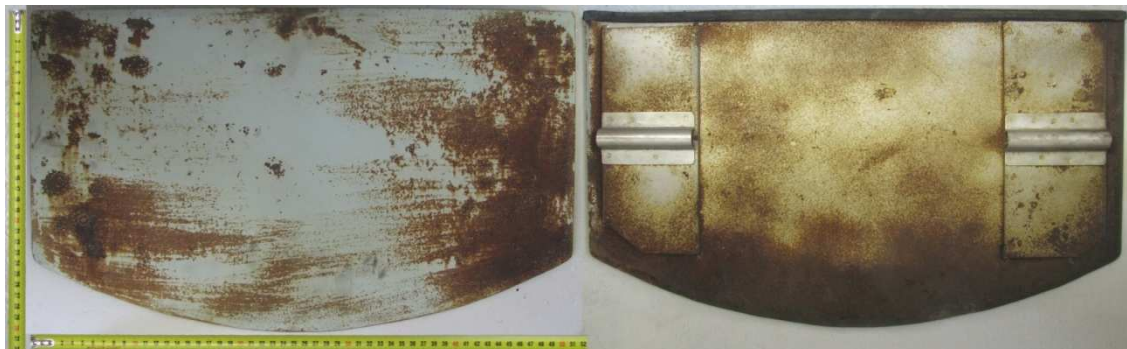
Kuva 64. VN2:n uudempi huoltoluukku [(23 - 30) x 51] cm edestä ja takaa 26.10.2010.
