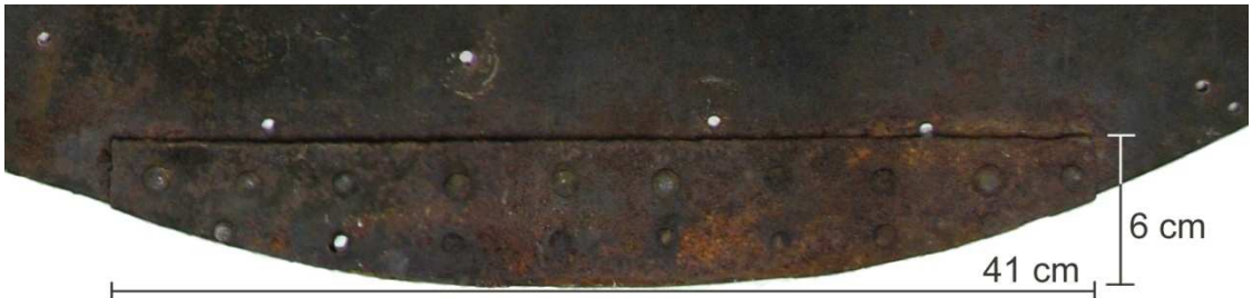
Kuva 73. VN2:n ruosteinen, kaksinkertainen ja niittaamalla kiinnitetty jatkopala takaa 3.12.2010.
