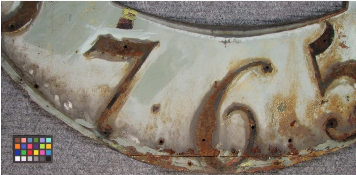
Kuva 29. VN2:n kellotaulun rautapellin alareunassa oli kaksinkertaisesta pellistä tehty jatkopala, joka oli kiinnitetty niittaamalla (kuva 3.12.2010). Ks. kuvat 73 ja 74, liite 4. Viimeisen (4.) vaaleanharmaan maalikerroksen jälkeen numeroiden viereistä ruostetta on vielä peitelty (5.) vaaleansinisellä maalilla.
