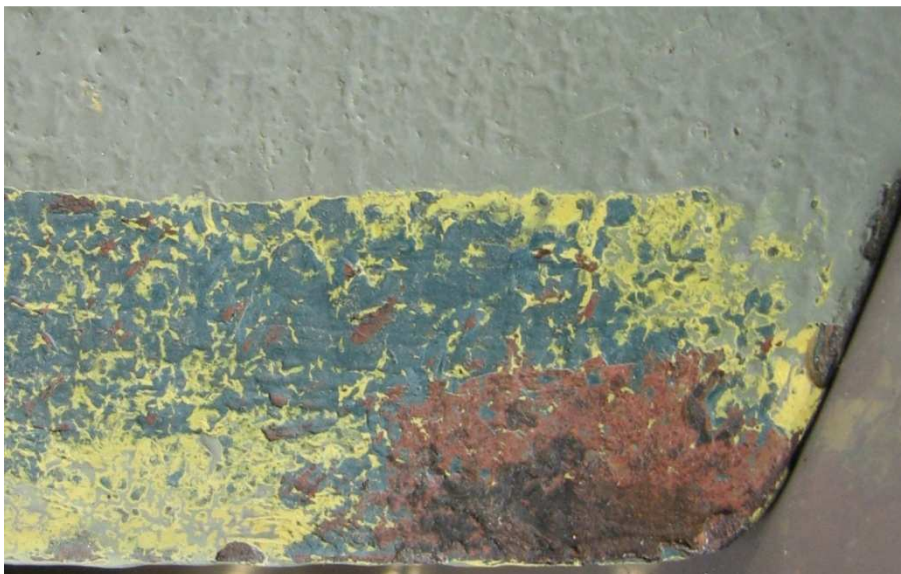
Kuva 30. Väriportaat VN2:n vanhemmassa huoltoluukussa 29.10.2010. Punainen ja keltainen ovat ruostesuojakerroksia. Musta, turkoosi ja vihertävänharmaa ovat maalikerroksia.
