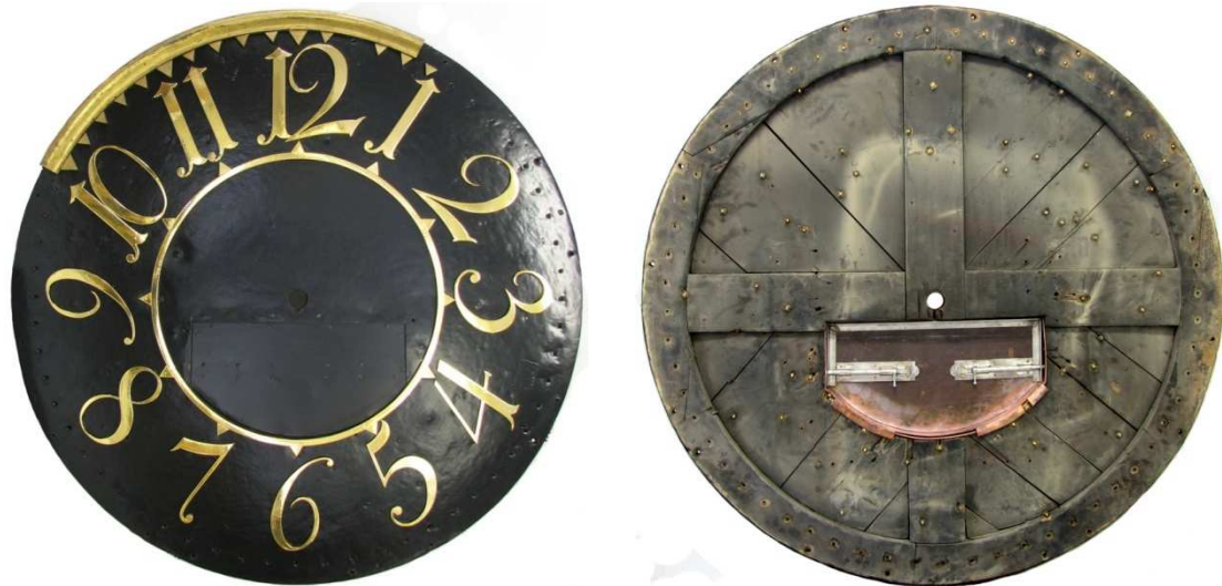
Kuva 5. VN1-kellotaulu restauroinnin aikana edestä ja takaa 14.3.2011. Sisemmän kullatun kehän halkaisija on 67,5 cm, leveys 15 mm, korkeus 8 mm ja valun ( \Gamma ) paksuus 3 mm.
