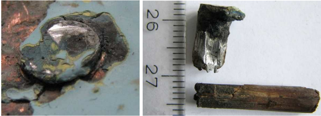
Kuva 13. Vasemmalla lyijy-tina -juotos pellin päällä 20.10.2010.
