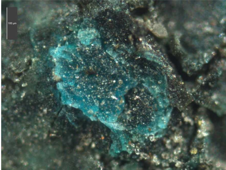
Kuva 39. VN1-3 huoltoluukun maalikerroksista alapuolelta. Kuparin korroosiotuote.
