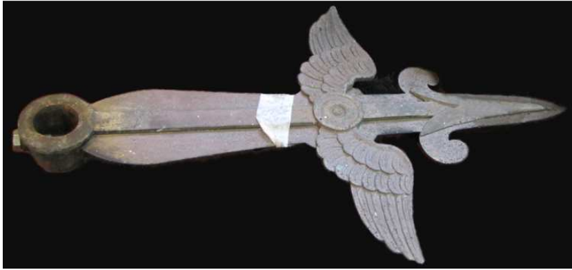
Kuva 24. VN1:n tuntiviisari 20.10.2010. Osoittimien kultauksesta ei ollut juuri mitään jäljellä.
