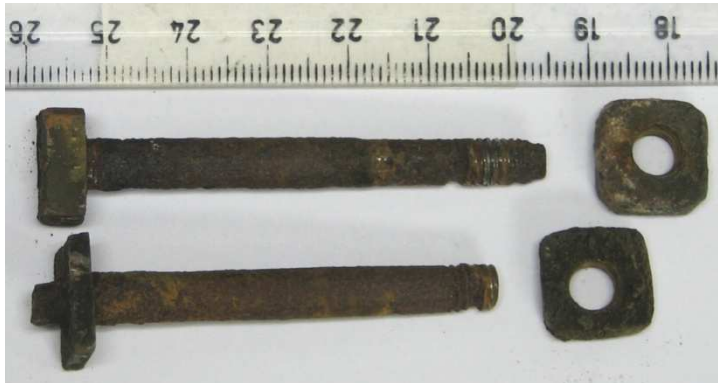
Kuva 21. Lähikuvassa VN1:n ulkokehyyksen vaarvoja ja muttereita 10.11.2010.
