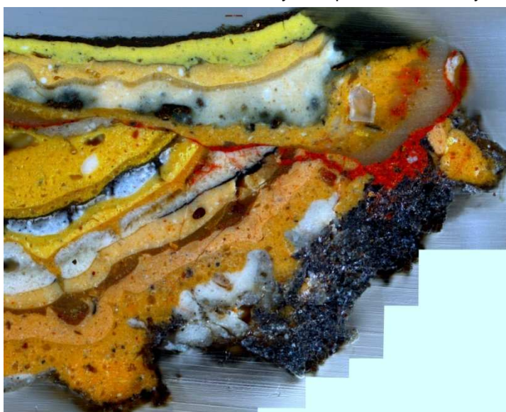
Kuva 35. VN2:n ulkokehyyksen poikkileikkausnäyte F8-1-3 kooste useasta kuvasta.
