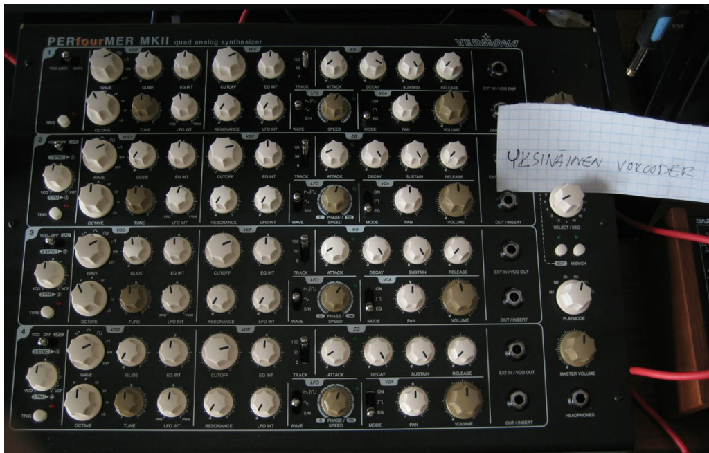
KUVA 14. Vokooderiäänessä käytetyn synteesisignaalin asetukset Vermona Perfourmer MK II syntesoiijassa. (Heikki Vastiala, 2014)
