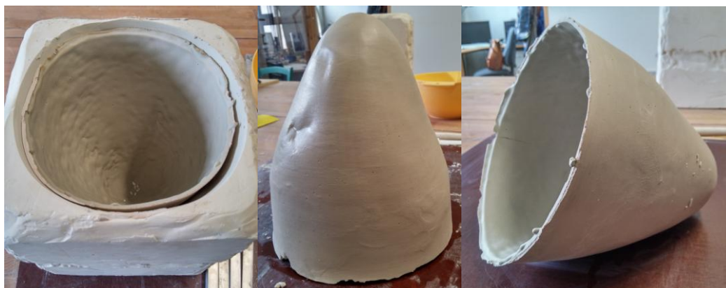
Kuva 20. Erotinaineen tuottama reaktio valun sisäpintaan.
