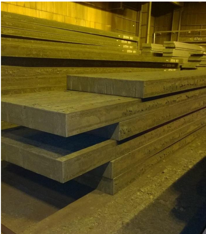
Kuva 9. Ahioiden päädyt jäähtyivät nopeammin, koska ahiot olivat erimittaisia.
