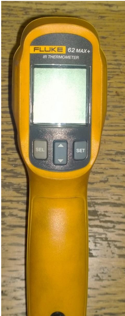
Kuva 7. Lämpömittalaite FLUKE 62 MAX+ (8.)
